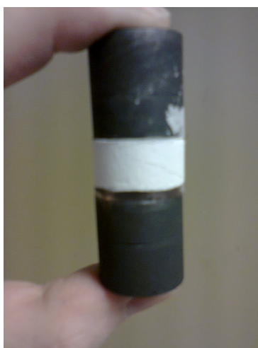
FIGURE 7.24 – Photographie pendant l'étape de démoulage. On distingue les deux pistons (en noir), la poudre d'alumine pour protéger les contacts (en blanc), et le transformateur fritté recouvert de papiex (en noir brillant).
