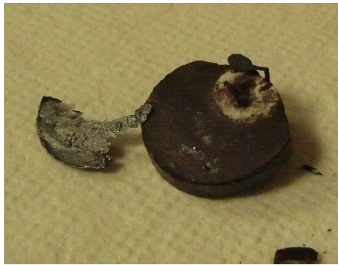
FIGURE 7.31 – Transformateur de la série des troisièmes essais recuit à 500 \text{ }^\circ\text{C} .
