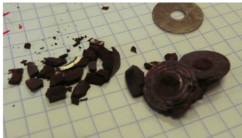
FIGURE 7.32 – Après recuit à 500 \text{ }^\circ\text{C} , les transformateurs s'effritent facilement.
