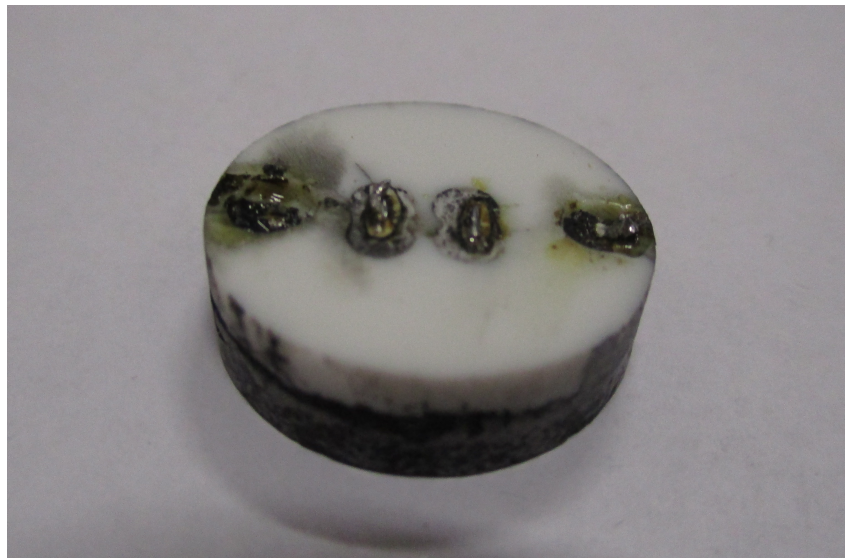
FIGURE 7.40 – Transformateur de la série des sixièmes essais. Diamètre 20 mm.
