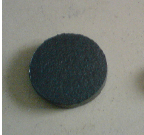
FIGURE 7.21 – Premier cofrittage de transformateur monolithique.
