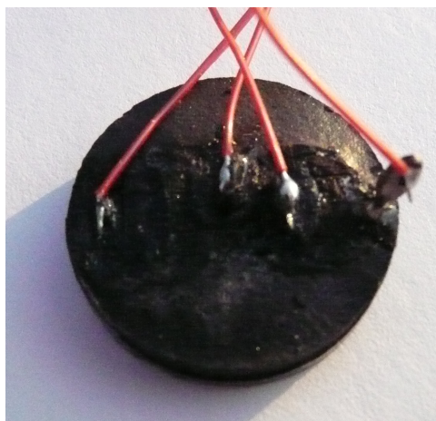
FIGURE 7.30 – Transformateur connecté de la série des troisièmes essais. Diamètre 20 mm.
