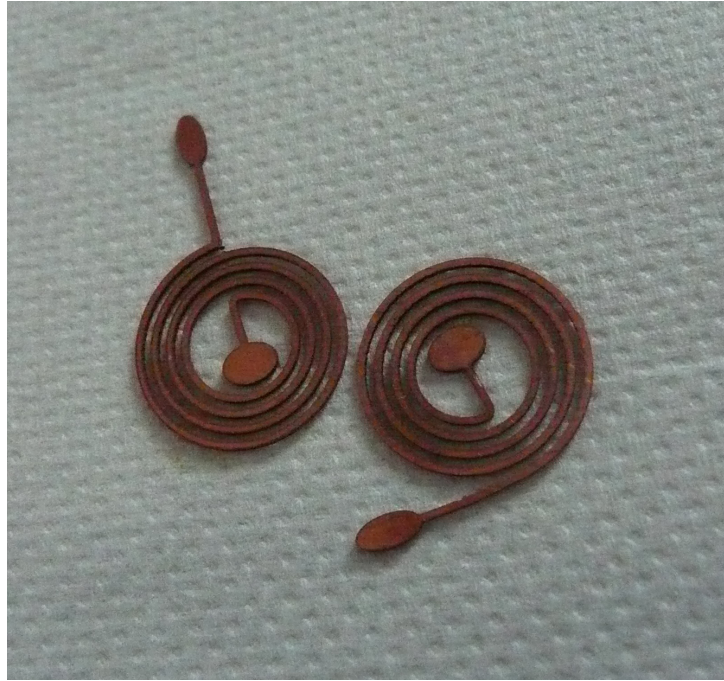
FIGURE 7.11 – Spirales usinées par électro-érosion.
