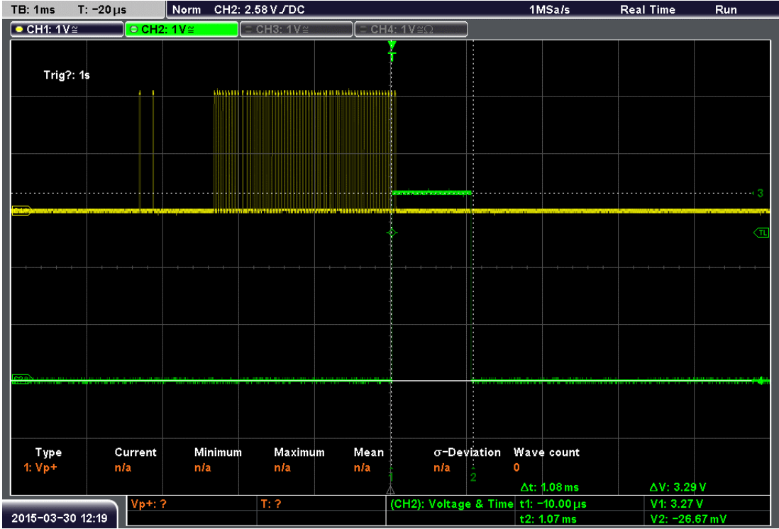
Figure VI-49 : Capture du signal démodulé retardé et du signal d'activation
