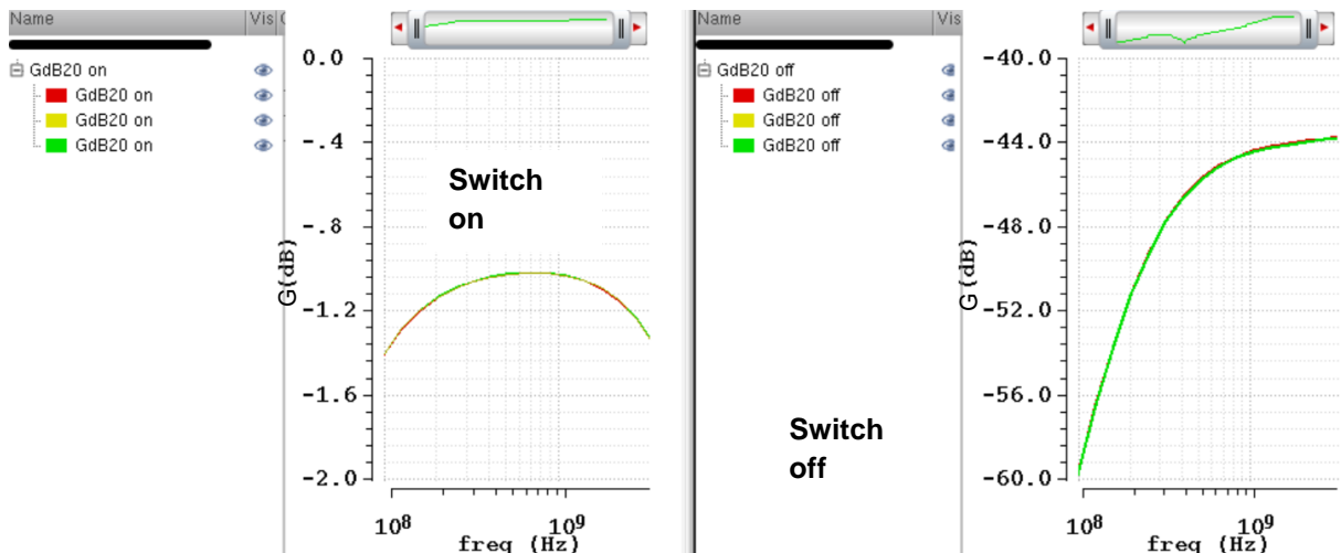
Figure VI-22 : Isolation des switches RF pour des variations de +/-10% de la tension d'alimentation
