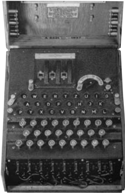
FIGURE 1.2 – Une machine Enigma prête à l'emploi : rotors installés à leur position initiale, tableau câblé. L'opérateur tape au clavier le texte à chiffrer, le texte chiffré s'allume sur la réplique du clavier au dessus, le premier rotor tournant à chaque frappe, en entraînant éventuellement avec lui d'autres rotors.
