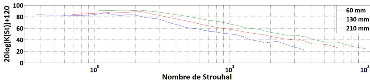
Figure V.19 : Coefficients  $K$  moyens en amont de l'association de deux diaphragmes suivant  $L$ .
