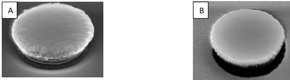
Figure 15. Observation des dépôts magnétiques de monocouche de NiFe sur des piliers de résine négative. (A) Dépôt réalisé par pulvérisation cathodique. (B) Dépôt réalisé par évaporation PVD (Physical Vapor Deposition).
