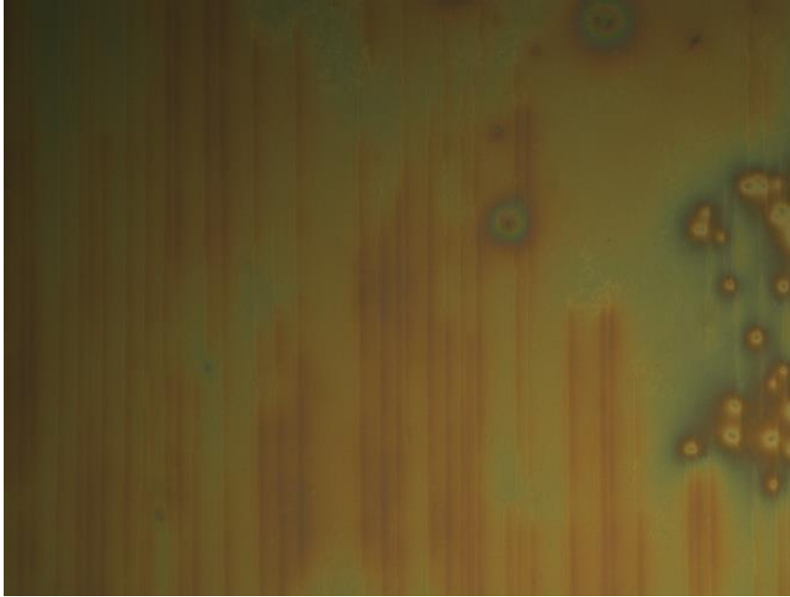
Figure 19 : stries huileuses observées en réflexion par microscopie optique polarisée. Les couleurs sont dues à l'interférence des réflexions sur les deux interfaces du film de cristal liquide, et peuvent être directement associées à l'épaisseur du film, en fonction de l'indice optique de celui-ci.
