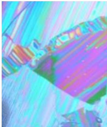
Figure 15 : Dépôt de cristal liquide sur du MoS 2 . On peut voir les axes distincts induits par l'ancrage sur chaque zone du substrat. L'ancrage est dirigé dans la direction perpendiculaire aux lignes observées. (Coursault, 2013)
