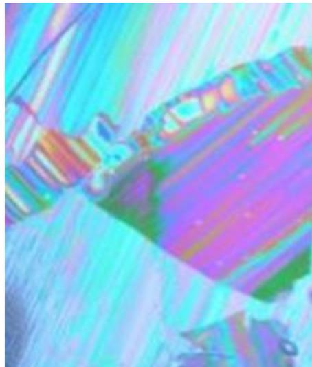
*Figure 15 : Dépôt de cristal liquide sur du MoS<sub>2</sub>. On peut voir les axes distincts induits par l'ancrage sur chaque zone du substrat. L'ancrage est dirigé dans la direction perpendiculaire aux lignes observées. (Coursault, 2013)*
