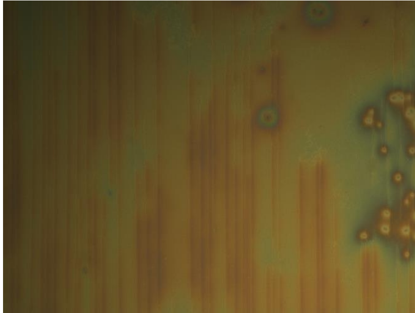
Figure 30 : Zone de 60 par 80 \mu\text{m} d'un échantillon de 8CB sur PVA frotté, observé en réflexion avec polariseur et analyseur croisés
