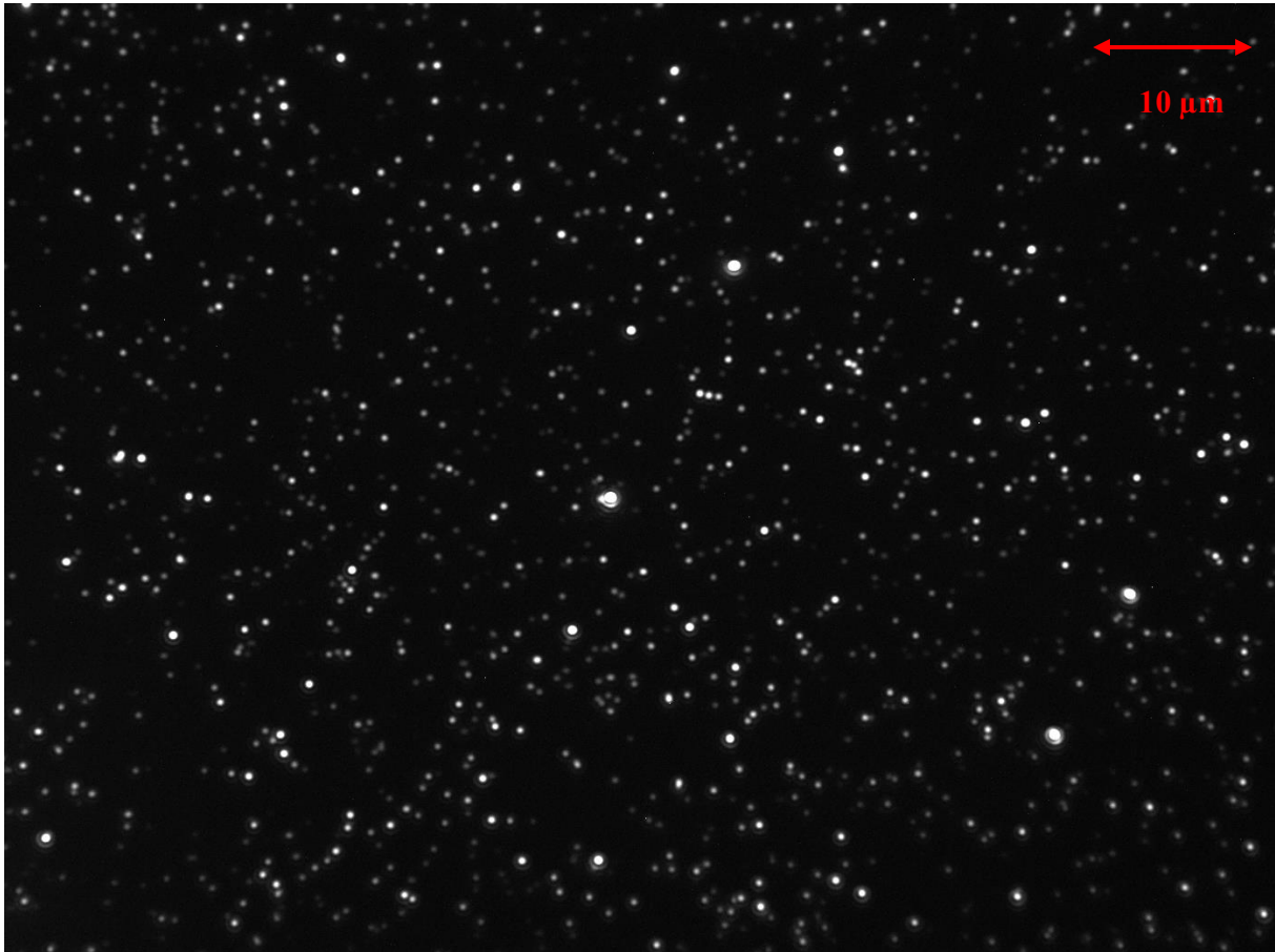
Figure 78 : image en photoluminescence d'un échantillon-type après filtrage de la lumière réfléchiée par les stries huileuses.
