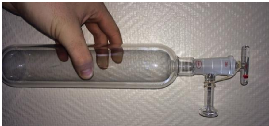
Figure IV-2 : Ampoules en verre de 500 ml utilisée pour les prélèvements de gaz.
