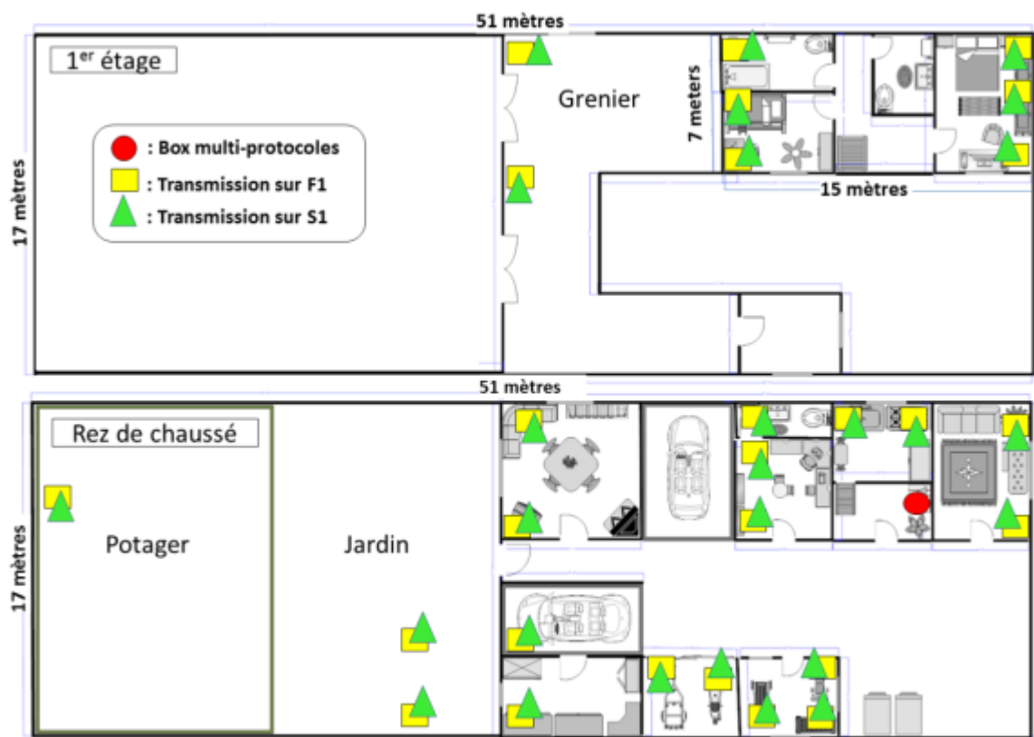
Figure IV-19 : Portée de KNX-RF à l'intérieur d'une maison sans interférences
