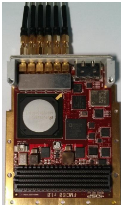
Figure III.4. Carte de conversion numérique analogique et analogique numérique
