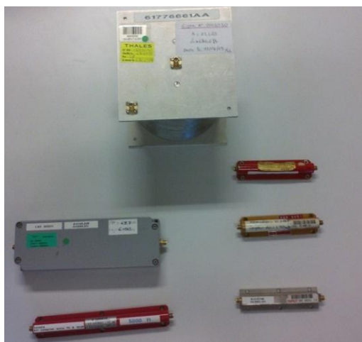
Figure I.12. Des lignes à retard utilisées chez THALES
