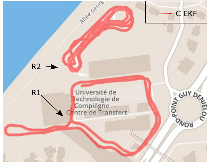
Figure 4.4 – Trajectoires de véhicules estimées par la méthode coopérative
