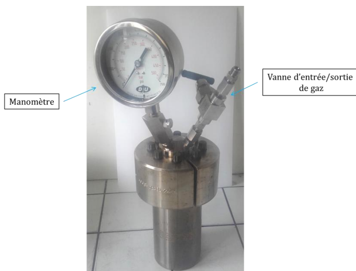
Figure II-1 : Réacteur Parr® utilisé pour les réactions solvothermales éthanol-sodium.
