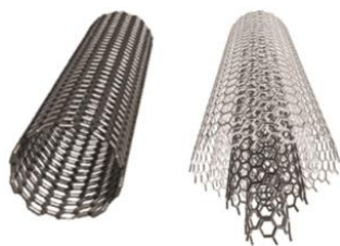
Figure I-5 : Nanotubes de carbone mono-feuillet (gauche) et multi-feuillets (droite).
