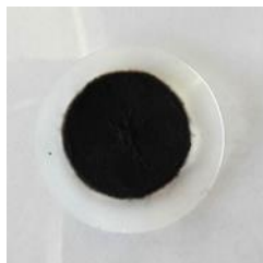
Figure VI-18 : Photographie du film obtenu par dispersion et filtration de l'échantillon MLG-Cs.
