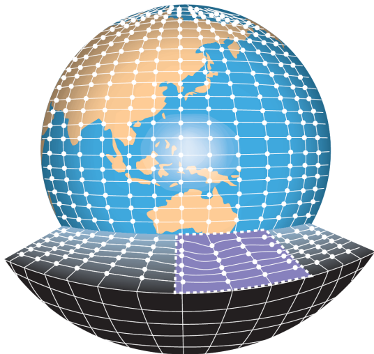
Figure 1.11 : Découpage de l'atmosphère pour la composante atmosphérique des GCMs de la NOAA, États-Unis.
