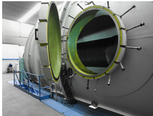
Figure 1.2 – Photographie de l'accélérateur électrostatique Tandem XTU du LNL [38].
