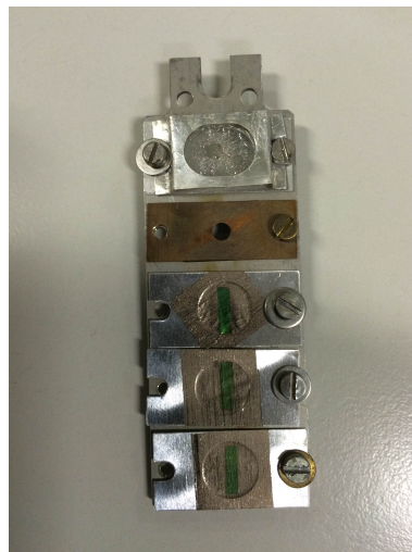
Figure 2.2 – Photographie du porte-cible de la chambre à réaction comportant, de haut en bas, un quartz, un collimateur et trois cibles de ^{40}\text{Ca} . Un dépôt d'une largeur de 2 mm a été imposé sur les cibles afin de s'assurer que le faisceau soit au centre de la cible.
