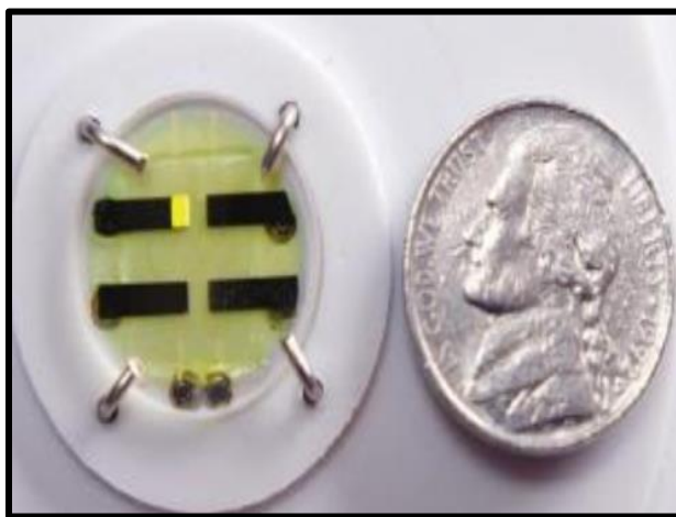
Figure 1-19. Dispositif "OILED" opérationnel basé sur la pérovskite hybride (C_{20}H_{22}S_2N_2)[PbCl_4] comme matériau émetteur. 11
