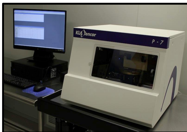
Figure 2-21. Profilomètre utilisé pour les mesures de l'épaisseur des couches minces de pérovskites hybrides.
