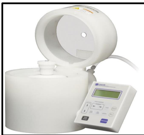
Figure 2-19. Spin-Coater (WS-400B-6NPP-LITE-1) utilisé pour la préparation des couches minces de pérovskites hybrides.
