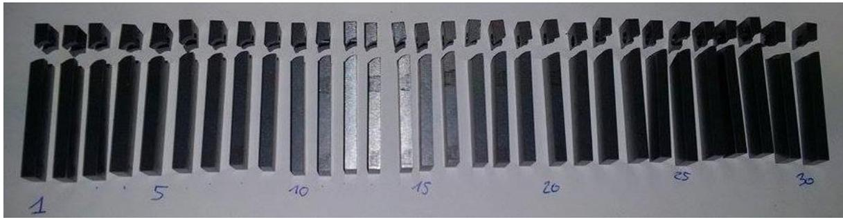
Figure 107 : Photographie des éprouvettes vissées après rupture, classées par ordre croissant du numéro d'essai.
