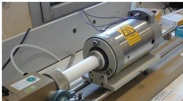
Figure 28 : Photographie de l'appareil de dilatométrie du CNES
