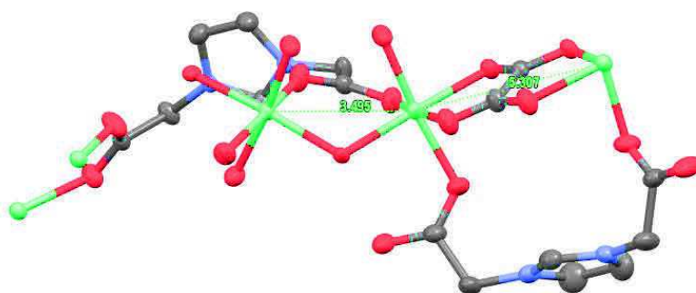
Figure 39 : distances entre les ions Ni 2+ du composé [Ni(L1)(ox) 0,5 (μ 2 -H 2 O) 0,5 ].
