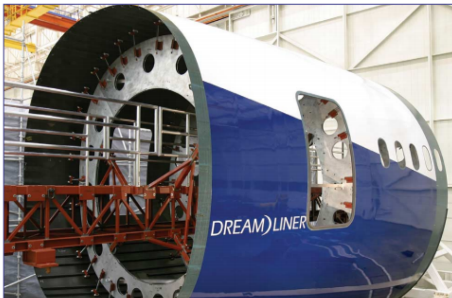
FIGURE 1 – La partie centrale du fuselage du Boeing 787 est composée de parties entières en fibres de carbone [Marsh, 2005].
