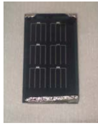
Figure 4.19. : Aperçu d'un échantillon du ZSW complété par une couche fenêtre électrodéposée et une grille métallique.
