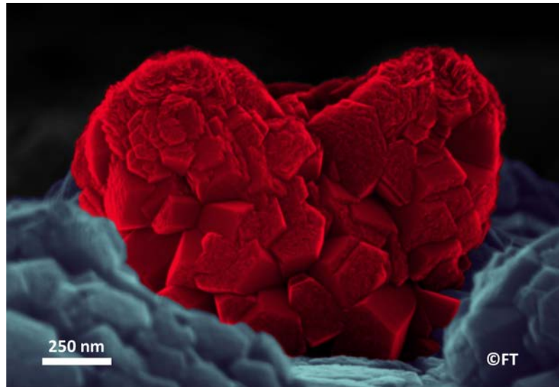
Figure C.2. : Même s'il nous en a fait baver durant tout ce temps, on ne peut qu'aimer le ZnO électrodéposé. ZnO ED en milieu perchlorate avec H_3BO_3 .
