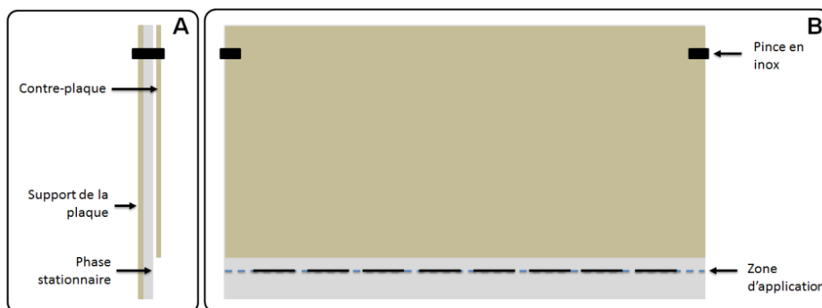
Figure 24: schéma de l'utilisation du mode « sandwich ». A : vue de profil ; B : vue de face.
