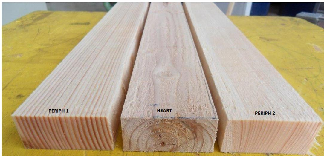
**FIGURE 3.9:** zones de découpe des éprouvettes
