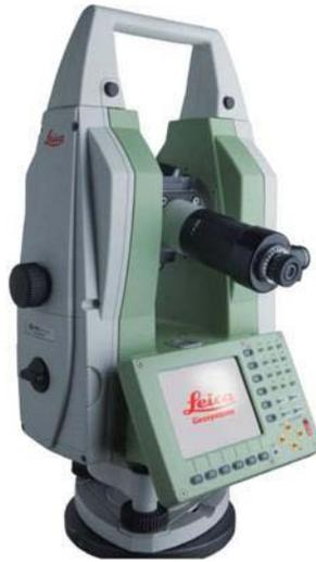
*Figure 2- 16 Théodolite TMC100A [Leica].*
