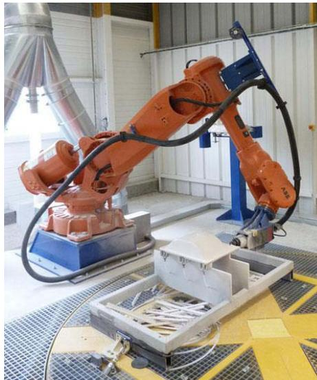
*Figure 1- 5 Robot ABB pour le fraisage [Machine-outil]*
