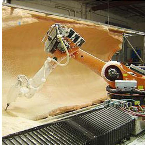
*Figure 1- 6 Robot Kuka pour l'usinage d'une pièce de grande dimension [Kuka]*
