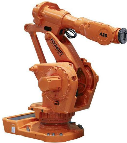
*Figure 2- 4 Robot ABB 6660.*
