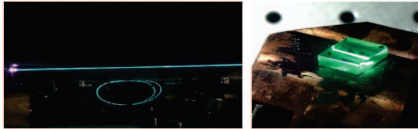
FIGURE 1.8 – Luminescence coopérative dans une fibre optique dopée Yb (à gauche) et dans un cristal d' \text{Yb} : \text{CaF}_2
