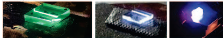
FIGURE 3.34 – Photos des différents cristaux Yb : CaF_2 utilisés dans cette étude.
