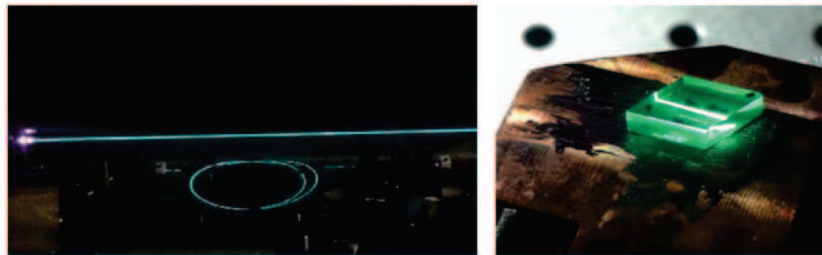
FIGURE 1.8 – Luminescence coopérative dans une fibre optique dopée Yb (à gauche) et dans un cristal d' Yb : CaF_2
