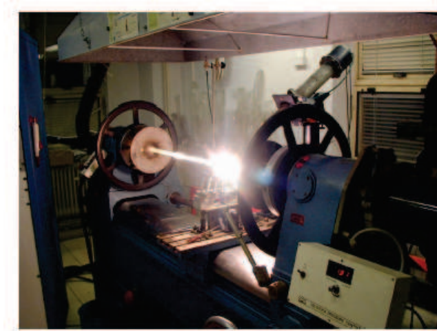
FIGURE 1.50 – Instrumentation pour réaliser la MCVD.
