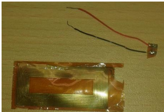
Figure 4.35 : Décollement des connexions métalliques et polyimide.
