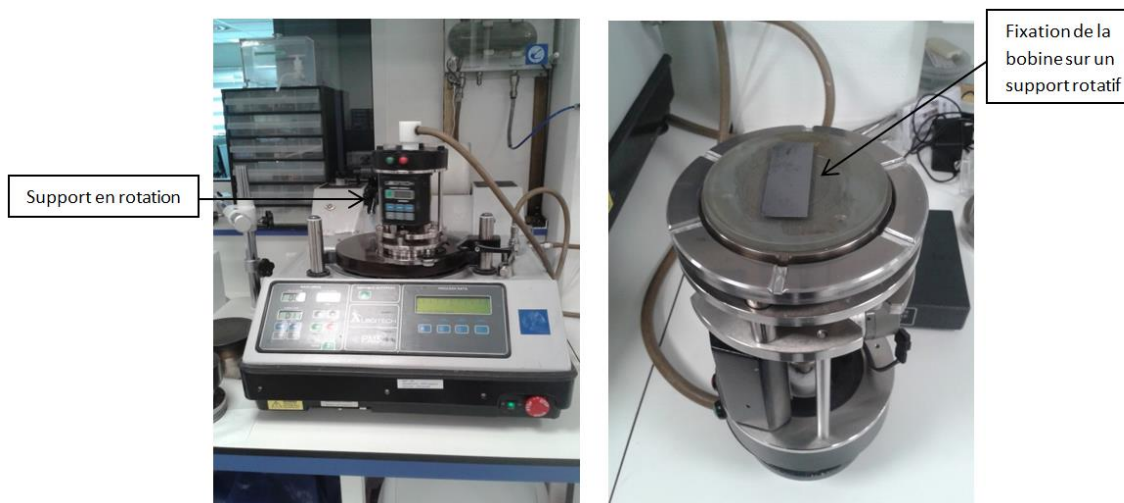
Figure 4.51 : Polissage des bobines de la recharge sans fil.
