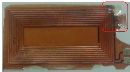
Figure 4.36 : Décollement d'une zone de cuivre.
