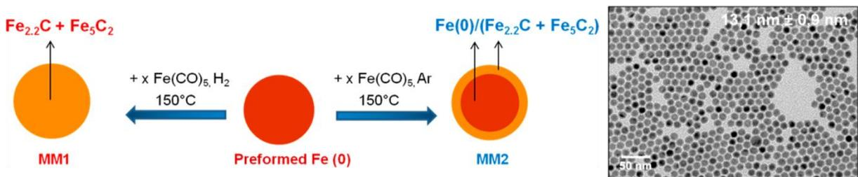
Figure 27 : Méthode de synthèse de nanoparticules de carbure de fer et de  $\text{Fe}@\text{carbure de fer}$ .<sup>[19]</sup>
