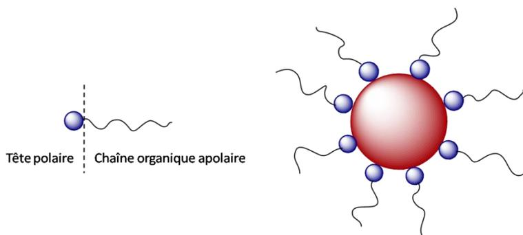
**Figure 13 : Représentation schématique du mode de stabilisation électrostérique.**
