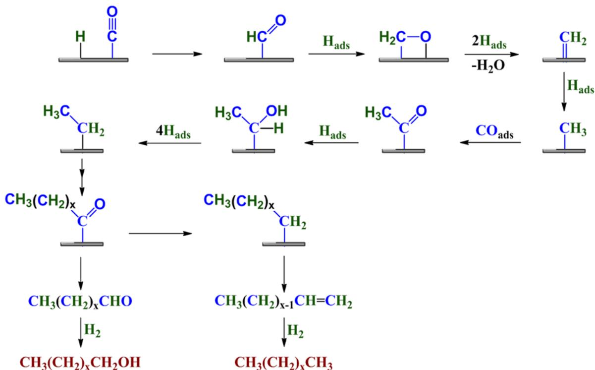
Figure 30 : Représentation du mécanisme oxygéné, inspiré de<sup>[94]</sup>.
