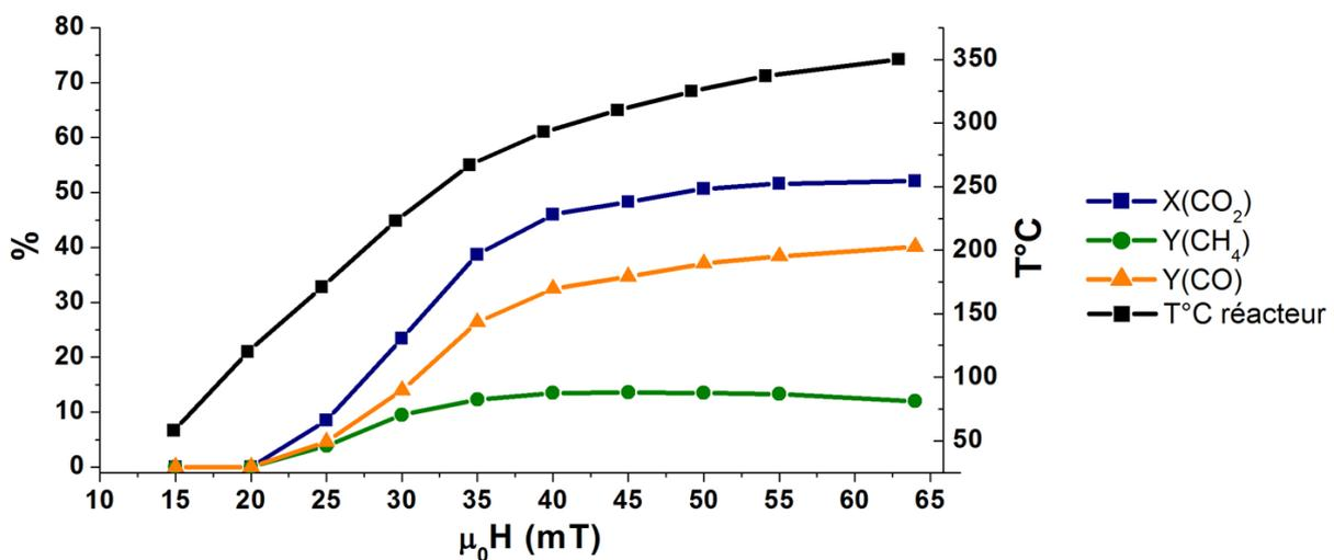
Figure 38 : Étude de l'influence de l'amplitude  $\mu_0 H_{rms}$  du champ magnétique sur les performances du catalyseur et la température du réacteur. (conditions :  $25 \text{ mL}\cdot\text{min}^{-1}$  ( $\text{H}_2/\text{CO}_2 = 4/1$ ),  $\text{VVH} = 1500 \text{ h}^{-1}$ )
