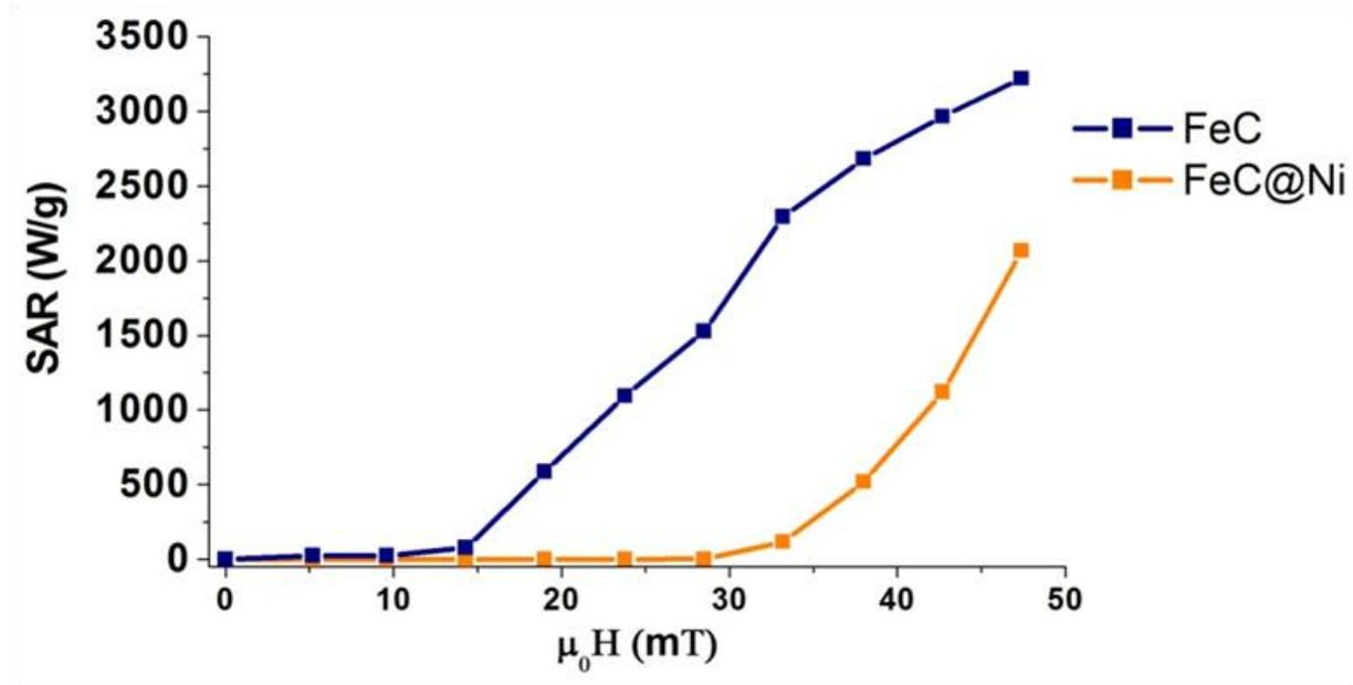
Figure 26 : Comparaison du SAR des nanoparticules de FeC et de FeC@Ni.
