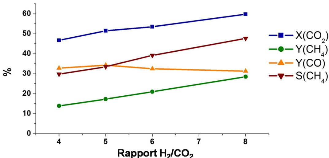
Figure 45 : Influence du rapport  $\text{H}_2/\text{CO}_2$  sur la conversion en  $\text{CO}_2$ , rendement et sélectivité en  $\text{CH}_4$ , et rendement en CO (débit =  $25 \text{ mL}\cdot\text{min}^{-1}$ ,  $40 \text{ mT}$ ,  $\text{VVH} = 1500 \text{ h}^{-1}$ ).
