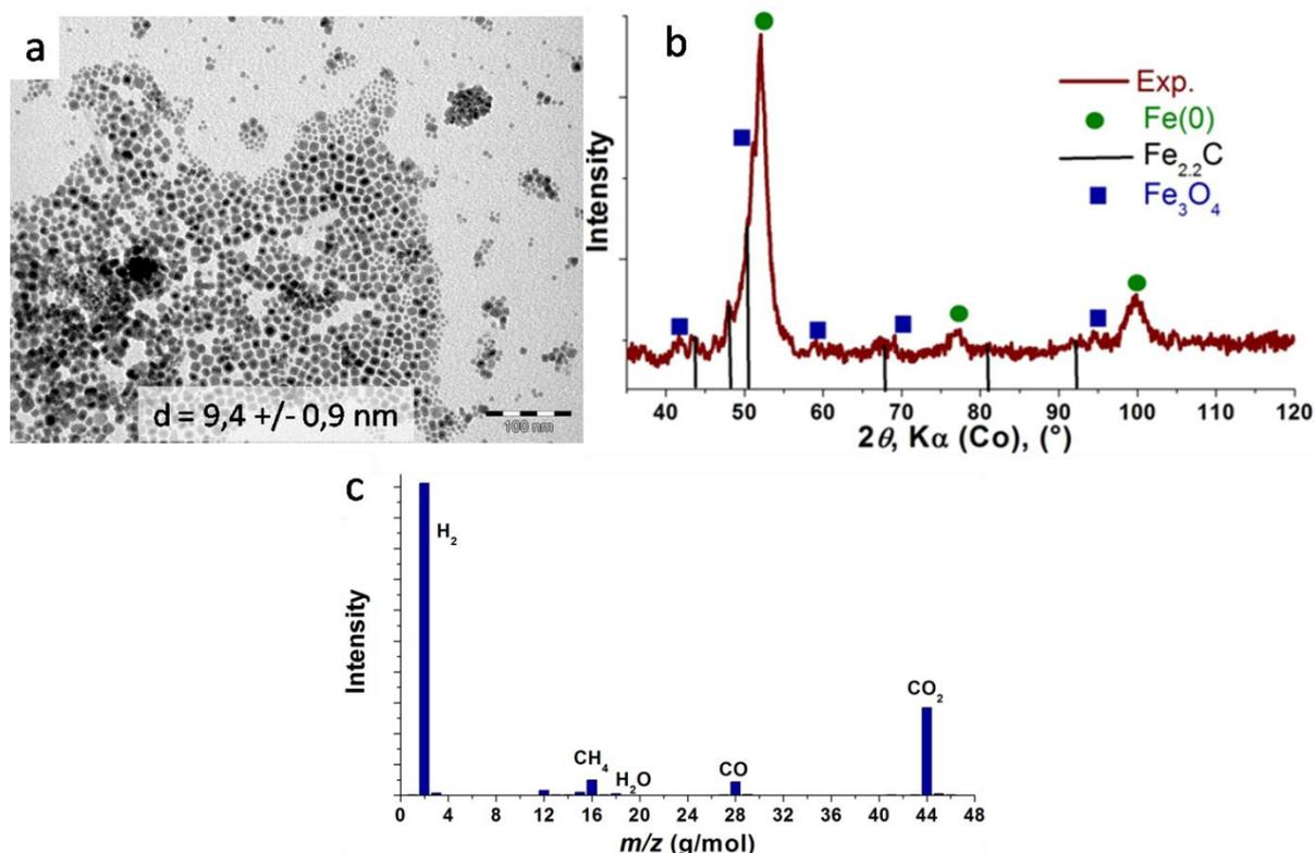
Figure 15 : Analyse des nanoparticules après réaction sous  $\text{CO}_2/\text{H}_2$  à  $230^\circ\text{C}$ . (a) MET (échelle : 100 nm), (b) DRX, (c) spectrométrie de masse.
