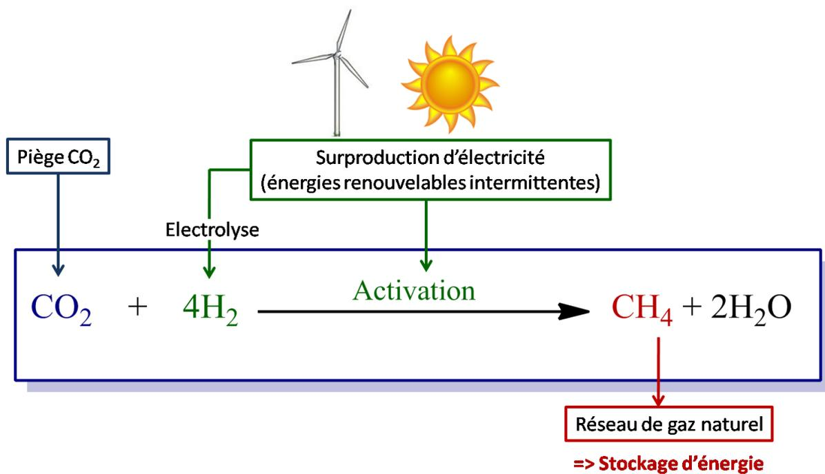
Figure 34 : Valorisation du CO<sub>2</sub> et stockage d'énergie via la réaction de Sabatier.
