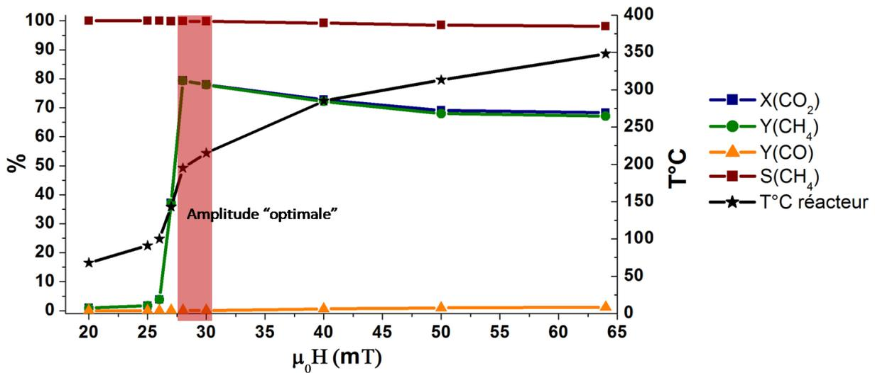
Figure 64 : Étude de l'influence de l'amplitude  $\mu_0 H_{rms}$  du champ magnétique sur les performances du catalyseur FeC@Ni-RuSiralox et la température du réacteur (25 mL.min<sup>-1</sup>, VVH = 1500 h<sup>-1</sup>).
