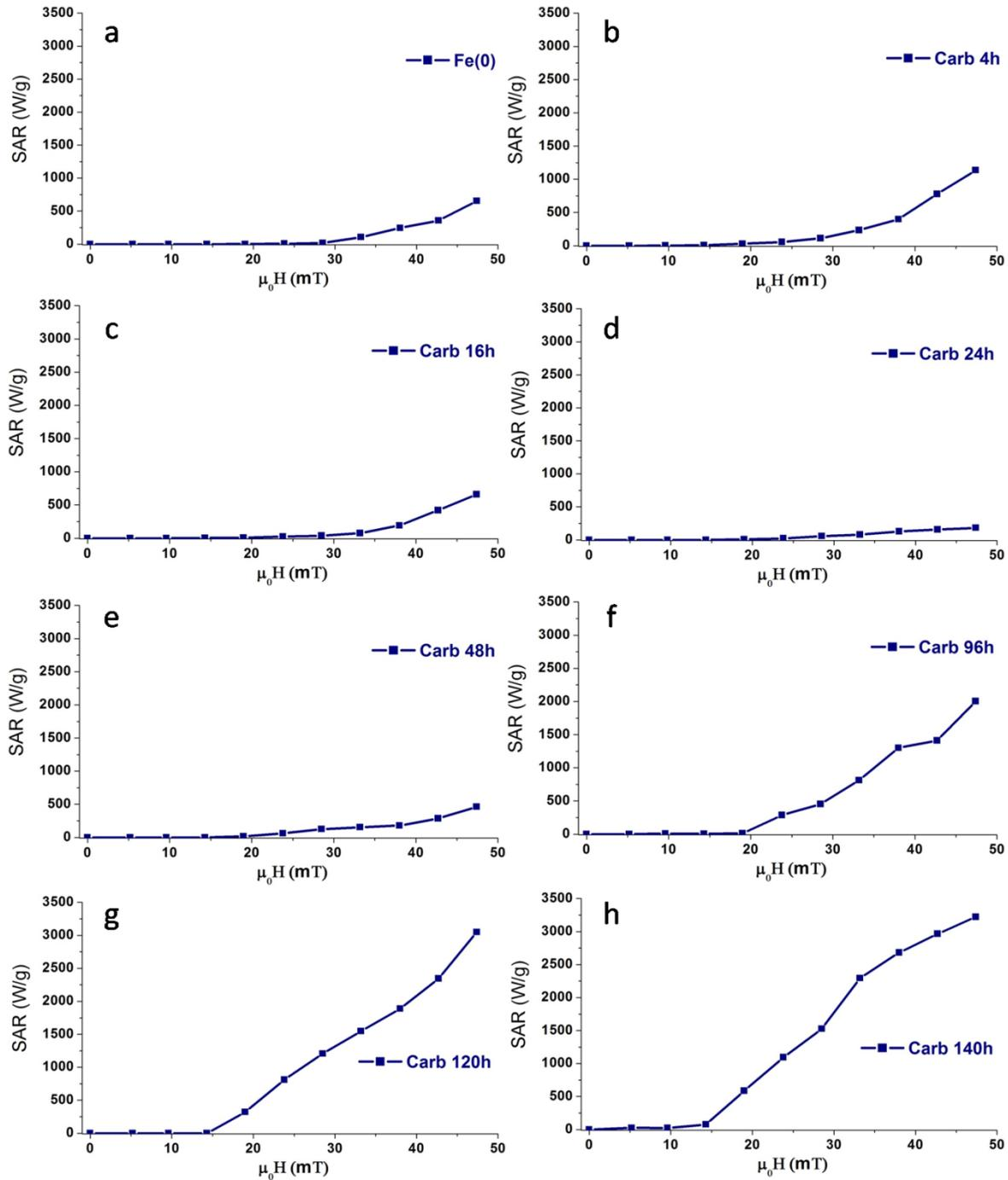
Figure 6 : : Mesures de  $SAR = f(\mu_0 H_{rms})$  pour les nanoparticules issues du système B. (a) Fe(0) de départ, (b) nanoparticules après 4 h de carburation, (c) 16 h, (d) 24 h, (e) 48 h, (f) 96 h, (g) 120 h, (h) 140 h.
