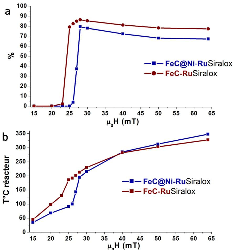
Figure 66 : Comparaison des systèmes FeC-RuSiralox et FeC@Ni-RuSiralox en fonction de  $\mu_0 H_{rms}$ . (a) rendement en méthane, (b) température de surface du réacteur. (conditions : 25 mL.min<sup>-1</sup>, VVH = 1500 h<sup>-1</sup>).
