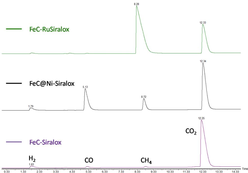
Figure 52 : Comparaison des chromatogrammes obtenus pour les systèmes FeC, FeC@Ni et FeC-RuSiralox dans des conditions identiques (40 mT,  $25 \text{ mL}\cdot\text{min}^{-1}$ ,  $VVH = 1500 \text{ h}^{-1}$ ).
