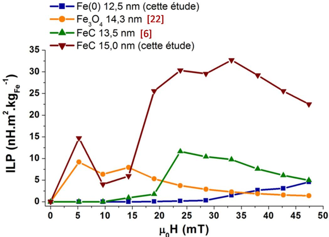
Figure 24 : Comparaison de l'*ILP* des nanoparticules de carbure de fer « optimales » de cette étude et des nanoparticules à base de fer disponibles dans la littérature (fréquence 100 kHz,  $\mu_0 H_{rms}$ ).
