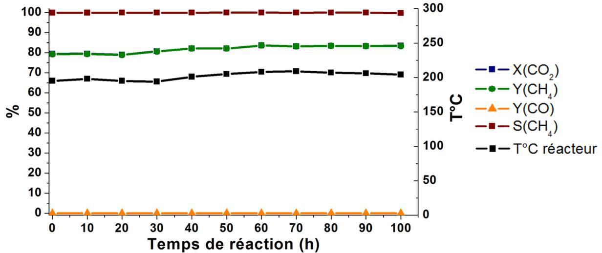
Figure 67 : Etude de stabilité du système FeC@Ni-RuSiralox (28 mT, 25 mL.min<sup>-1</sup>, VVH = 1500 h<sup>-1</sup>). Chaque point correspond à un arrêt/reprise de la catalyse.
