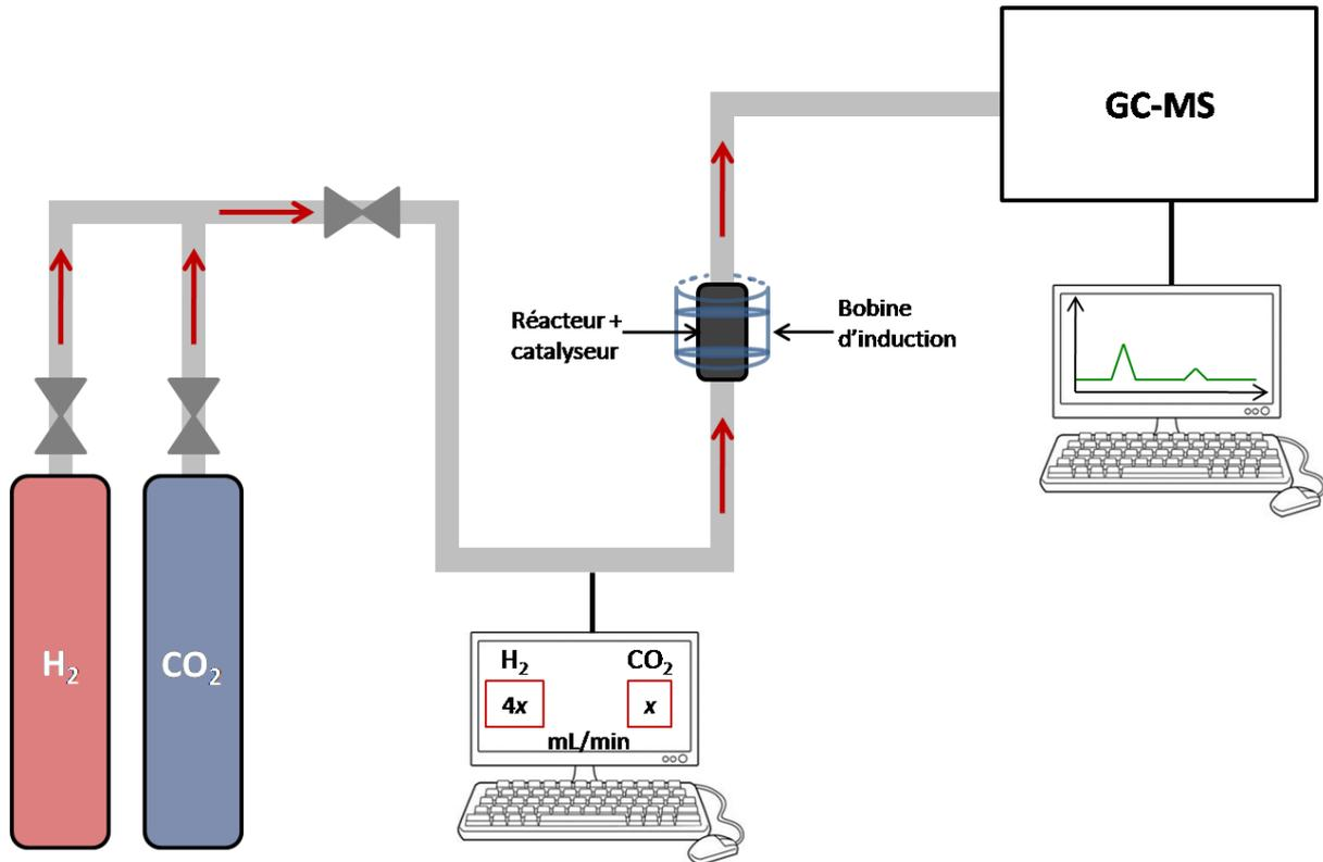
Figure 19 : Représentation schématique du procédé de méthanation par catalyse par induction magnétique.
