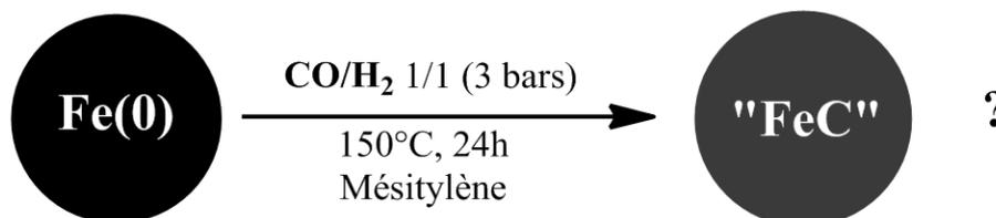
Figure 3 : Test de carburation de nanoparticules de Fe(0) sous CO/H<sub>2</sub>.
