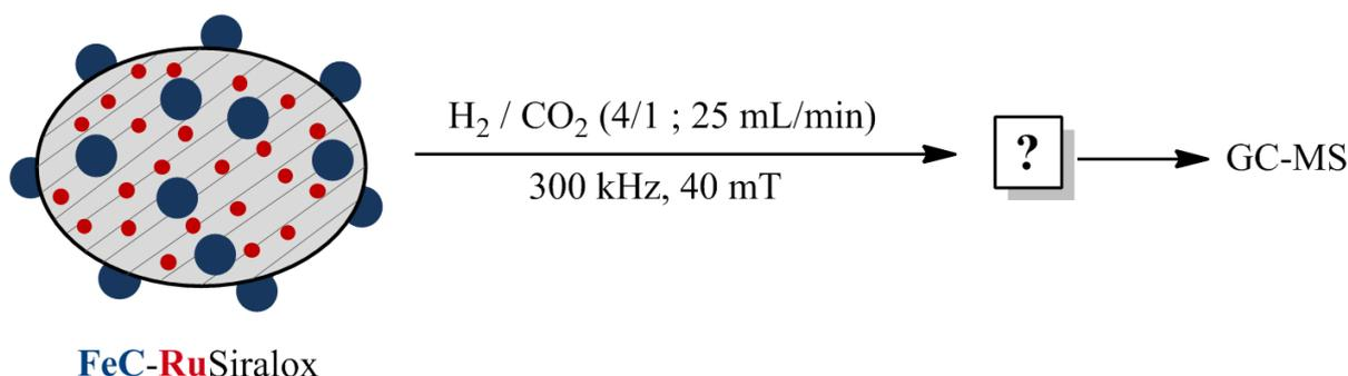
Figure 50 : Conditions choisies pour la mise en œuvre du premier test catalytique en réacteur continu avec FeC-RuSiralox.
