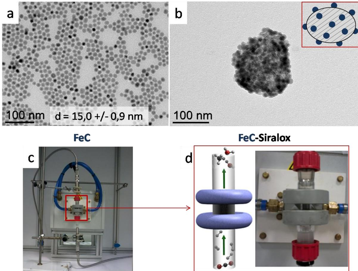
Figure 24 : Test du catalyseur FeC-Siralox en réacteur à flux continu. (a) image MET des nanoparticules de FeC, (b) nanoparticules de FeC supportées sur Siralox, (c) et (d) photos du réacteur chargé en catalyseur.
