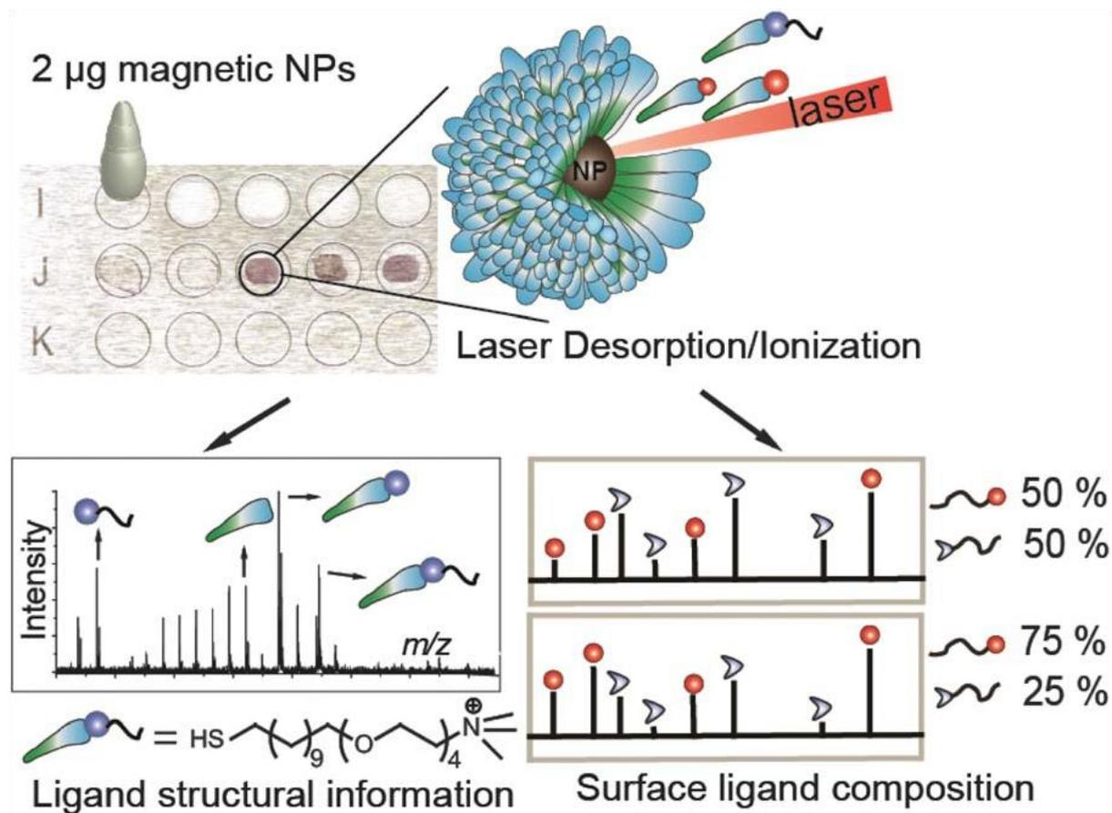
Figure 6 : Caractérisation structurale et quantitative des ligands présents à la surface de nanoparticules métalliques par LDIMS. Figure tirée de.<sup>[4]</sup> symboles bleus, rouges, gris : fonction des ligands.
