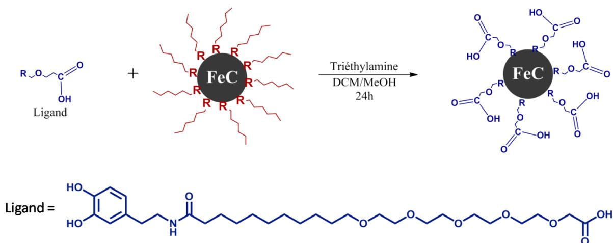
Figure 17 : Fonctionnalisation des nanoparticules de FeC par le ligand DOP-TEG-COOH.
