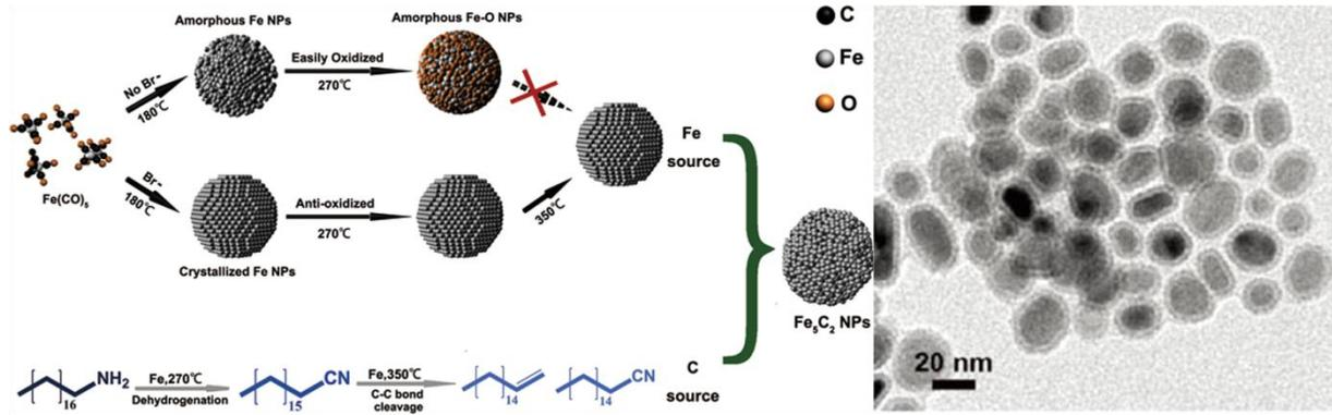
Figure 26 : Voie de synthèse de nanoparticules de carbure de fer  $\text{Fe}_5\text{C}_2$ .<sup>[74]</sup>
