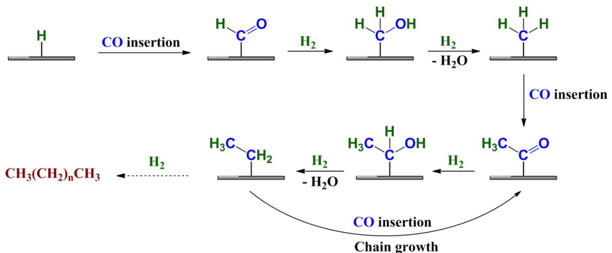
Figure 31 : Représentation du mécanisme par insertion de CO, inspiré de<sup>[94]</sup>.
