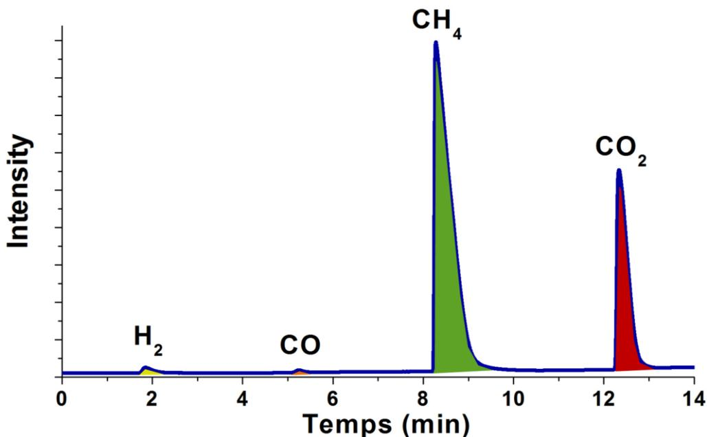
Figure 51 : Chromatogramme typique obtenu pour une réaction effectuée à 40 mT,  $25 \text{ mL}\cdot\text{min}^{-1}$  ( $H_2/CO_2 = 4/1$ ),  $VVH = 1500 \text{ h}^{-1}$ .
