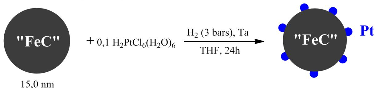
Figure 10: Protocole de synthèse des nanoparticules de FeC@Pt.
