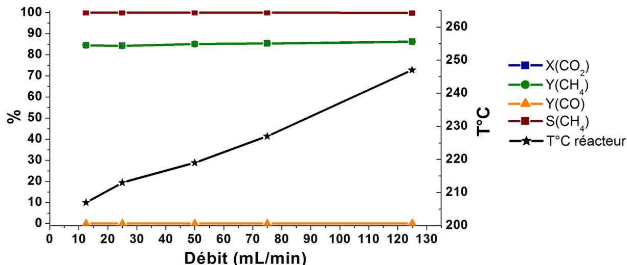
Figure 58 : Influence du débit total sur la conversion en CO<sub>2</sub>, rendement et sélectivité en CH<sub>4</sub>, rendement en CO, et sur la température de surface du réacteur. (amplitude  $\mu_0 H_{rms} = 40$  mT)
