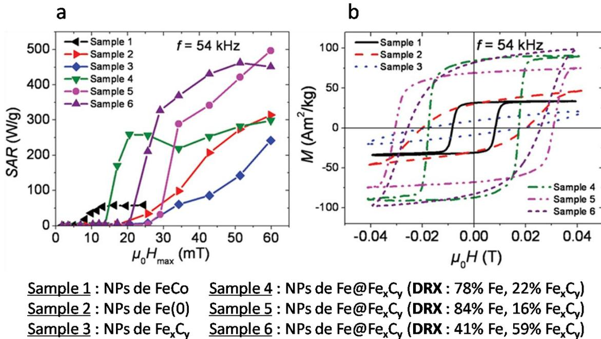
Figure 32 : Propriétés hyperthermique des nanoparticules de Fe(0), Fe(0)@Fe<sub>x</sub>C<sub>y</sub> et Fe<sub>x</sub>C<sub>y</sub> issues de la littérature.<sup>[5]</sup> (a) Valeurs de SAR, (b) cycles d'hystérésis haute fréquence.
