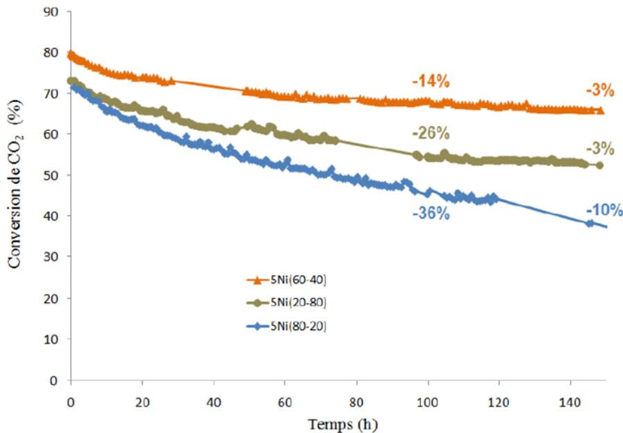
Figure 72 : Suivi de stabilité de catalyseurs à base de nickel parmi les plus actifs décrits dans la littérature.<sup>[5]</sup>
