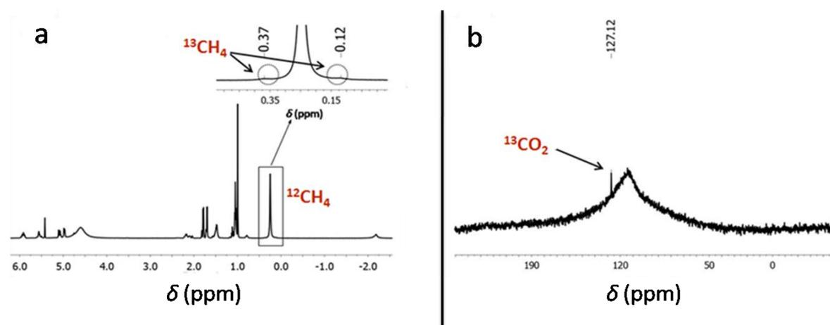
Figure 15 : Analyse RMN après synthèse Fischer-Tropsch à 250°C. (a) spectre RMN <sup>1</sup>H, (b) spectre RMN <sup>13</sup>C{<sup>1</sup>H}.
