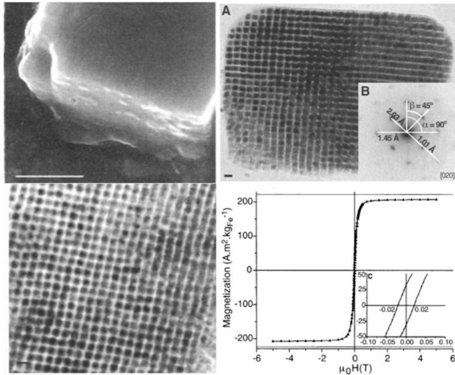
Figure 24 : Super-réseaux de nanocubes de fer obtenus par décomposition de  $\text{Fe}\{\text{N}[\text{Si}(\text{CH}_3)_3]_2\}_2$  sous  $\text{H}_2$ .<sup>[64]</sup>
