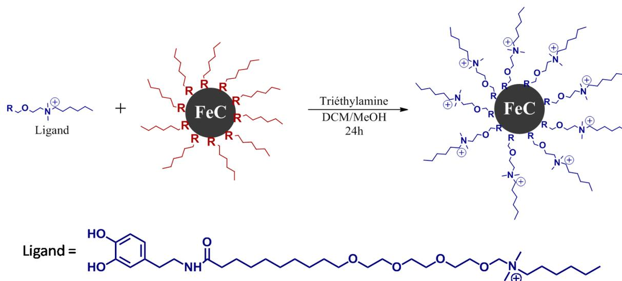
Figure 9 : Fonctionnalisation des nanoparticules de FeC par le ligand DOP-TEG-C<sub>6</sub>.
