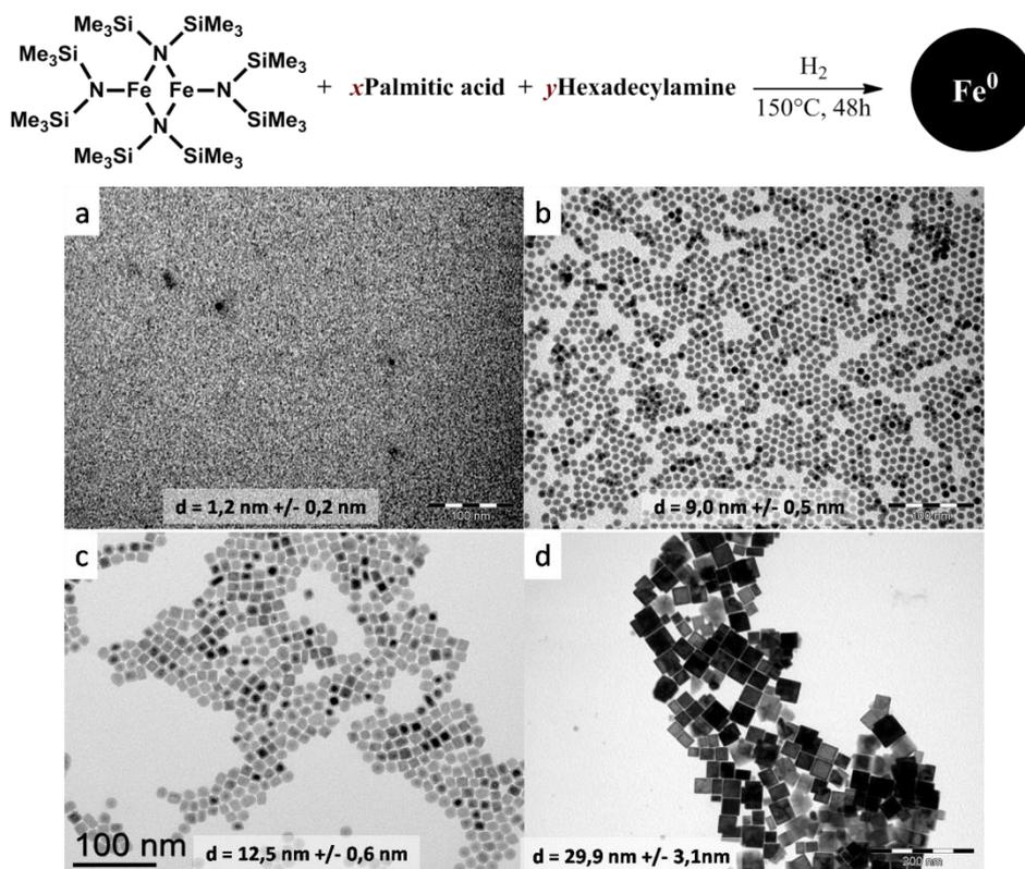
Figure 1 : Synthèse de nanoparticules de  $\text{Fe}(0)$  de différentes tailles. (a) en l'absence de ligands (échelle : 100 nm), (b) 1 Eq HDA + 1,2 Eq AP (échelle : 100 nm), (c) 1 Eq HDA + 1,3 Eq AP, (d) 1 Eq HDA + 1,6 Eq AP (échelle : 200 nm).
