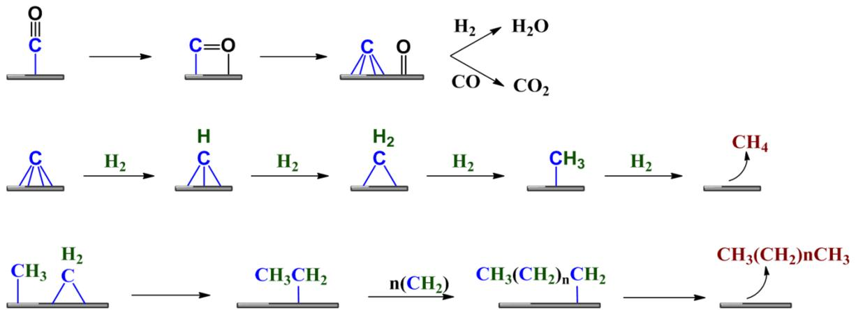
Figure 29 : Représentation du mécanisme de carbure de surface, inspiré de<sup>[94]</sup>.
