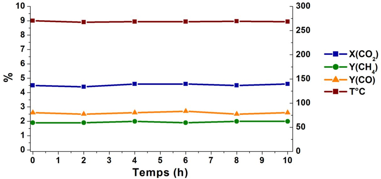
Figure 31 : Suivi de stabilité du système catalytique FeC-Siralox (40 mT, 25 mL.min<sup>-1</sup>, VVH = 1500 h<sup>-1</sup>).
