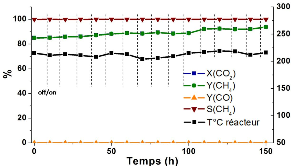
Figure 60 : Etude de stabilité du système FeC-RuSiralox (conditions : 28 mT, 25 mL.min<sup>-1</sup>, H<sub>2</sub>/CO<sub>2</sub> = 4/1, VVH = 1500 h<sup>-1</sup>).
