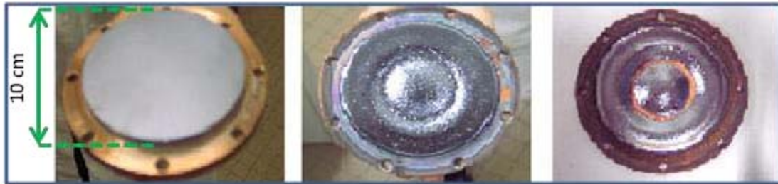
Figure 15. Différents états d'une cible utilisée en pulvérisation magnétron: de gauche à droite, une cible neuve, moyennement usée et très usée.
