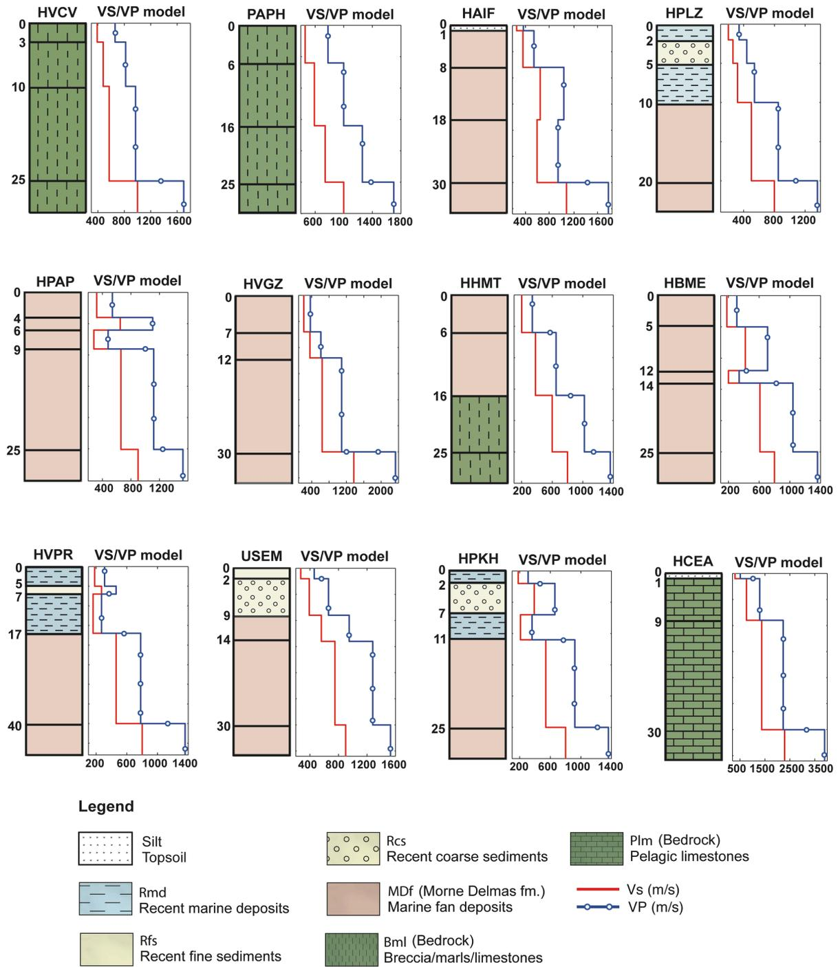
**Figure 2.7.-** Colonnes de sol pour les sites à proximité des stations sismologiques de Port-au-Prince, avec le contexte géologique local et les profils de vitesse associés. Les limites des couches sont déterminées en fonction du contraste de vitesse des ondes P et S mesurée à partir d'essais MASW (Cox et al., 2011) ; la géologie est extraite de la carte de la Figure 2.8 et le rapport  $V_p/V_s$  est considéré comme constant et égal à 1.7.
