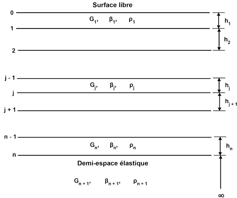
**Figure 5.1.-** Modèle de structures multicouches viscoélastiques se trouvant au-dessus d'un demi-espace élastique utilisé pour développer l'approche théorique de la méthode de simulation numérique 1D de la réponse sismique du sol (Schnabel et al., 1972).
