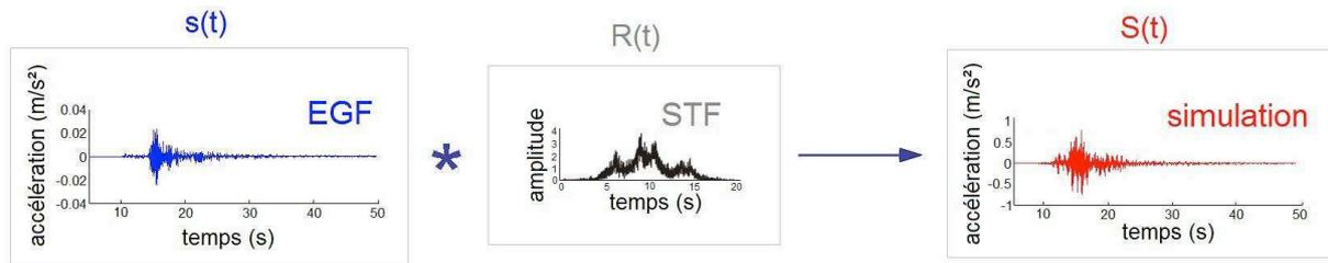
**Figure 6.3.-** L'accélérogramme  $S(t)$  du séisme cible obtenu par le produit de convolution entre l'enregistrement du petit séisme  $s(t)$  et une fonction source numérique  $R(t)$  (Honoré-Foundotos, 2008).
