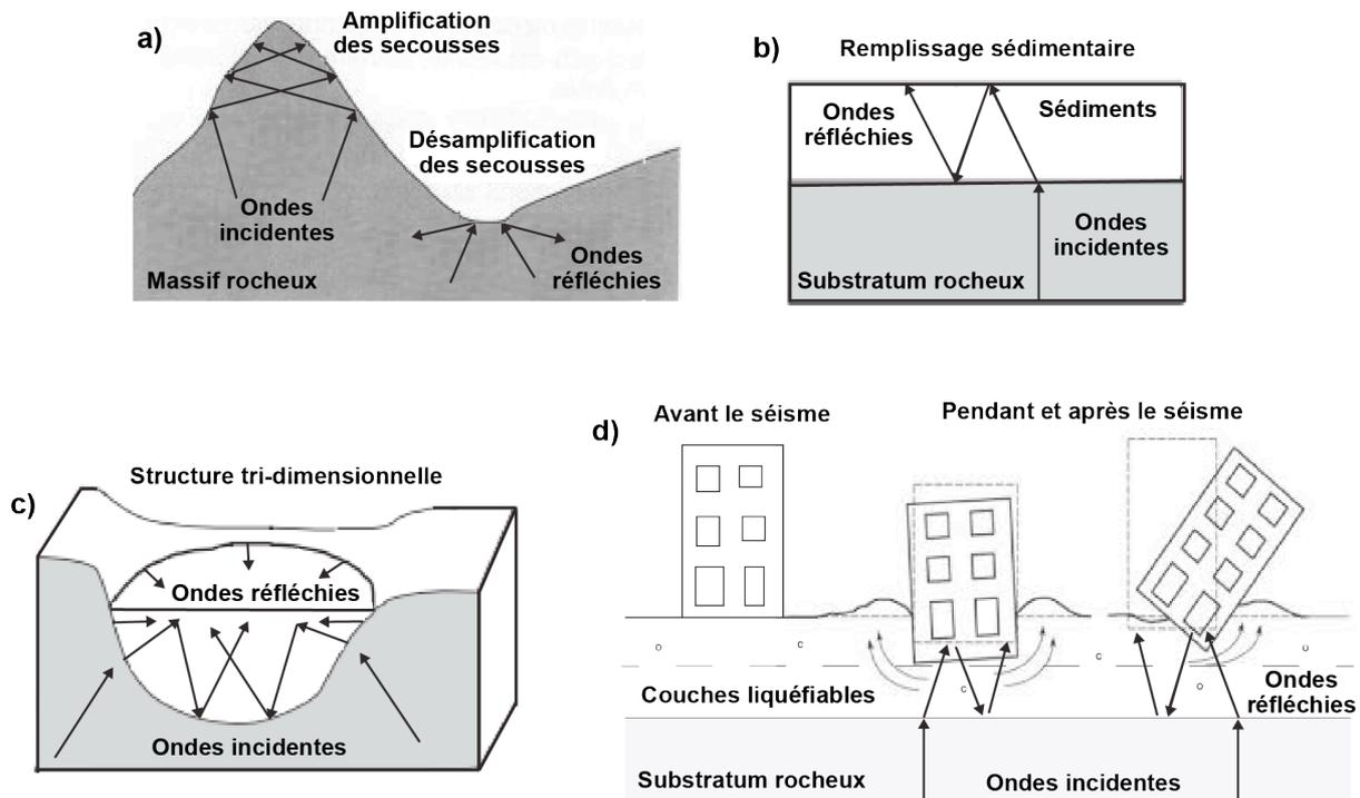
**Figure 4.3.-** Schéma résumant les différents effets liés à la propagation des ondes sismiques dans le sol. **a)** Piégeage des ondes dans les reliefs à rupture de pente marquée. **b)** Réflexion des ondes incidentes dans un modèle tabulaire (effets de site 1D). **c)** Effet de site dans un bassin sédimentaire (effets 3D). **d)** Liquéfaction du sol sous sollicitations sismiques, produite par des effets non-linéaires [source : Cornou, (2002) - Google Images].
