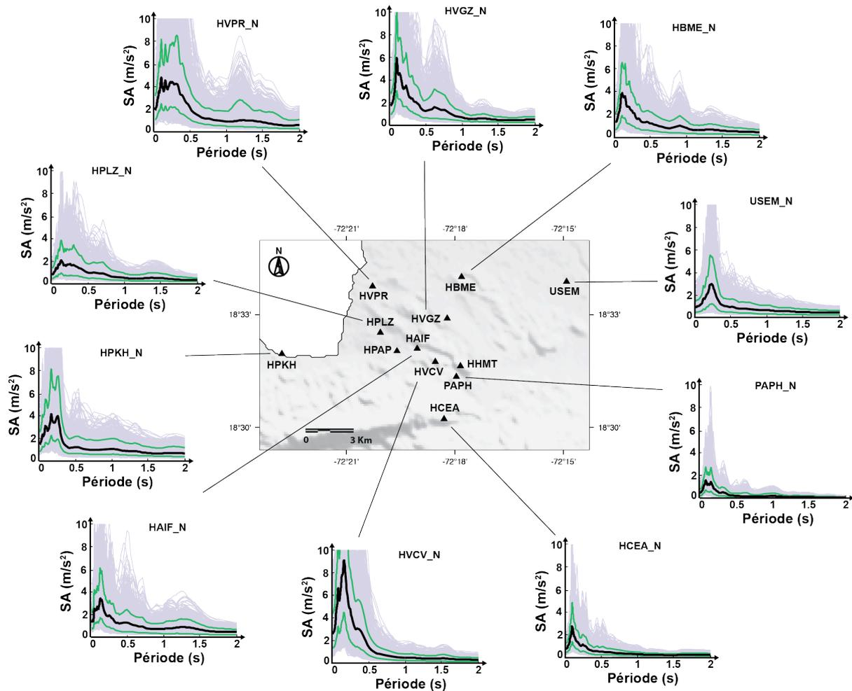
**Figure 6.17.-** Spectres de réponse en accélération (5% d'amortissement critique) calculés à partir des simulations (en mauve clair) d'un séisme cible  $M_w=6.5$  avec l'EGF du 03 mai 2010 (19h21,  $m_w=4.4$ ) pour chaque station (composante nord-sud). La médiane (ligne noire) et les 16ème et 84ème percentiles (lignes vertes) sont calculés sur l'ensemble des 1000 simulations.
