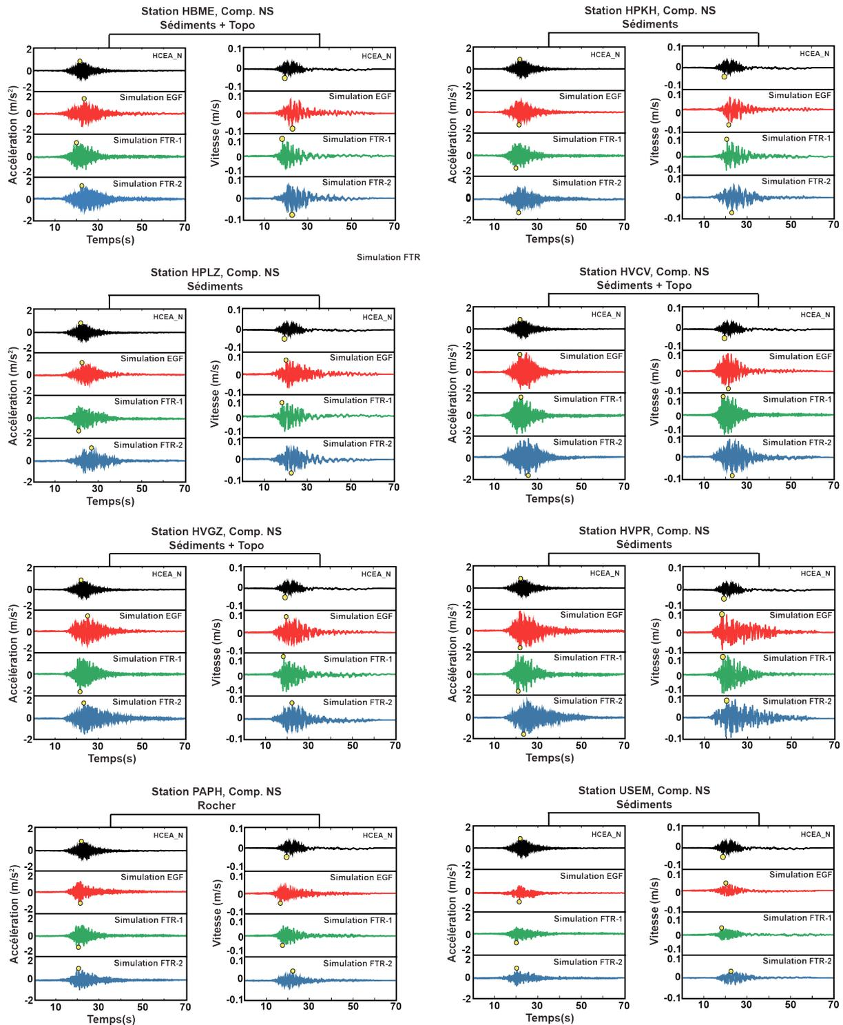
Simulation FTR-1 : Simulation avec la méthode des Fonctions de transferts, en utilisant la phase de HCEA.
