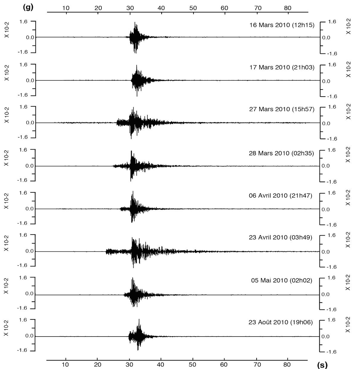
**Figure 5.3.-** Signaux enregistrés à la station HCEA (composante nord-sud) et testés comme mouvement d'entrée dans le code CyberQuake. L'accélérogramme du 16 mars 2010 (12h15) a été retenu pour la simulation numérique de l'effet de site.
