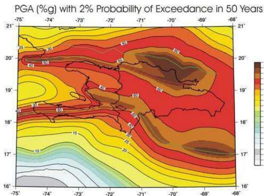
**Figure 4 :** Carte d'aléa sismique montrant l'accélération du sol maximale ayant 2% de chance d'être dépassée dans un intervalle de temps de 50 ans. L'accélération est exprimée ici en pourcentage de l'accélération de la gravité (% de g, 1 g = 10 m/s/s).
