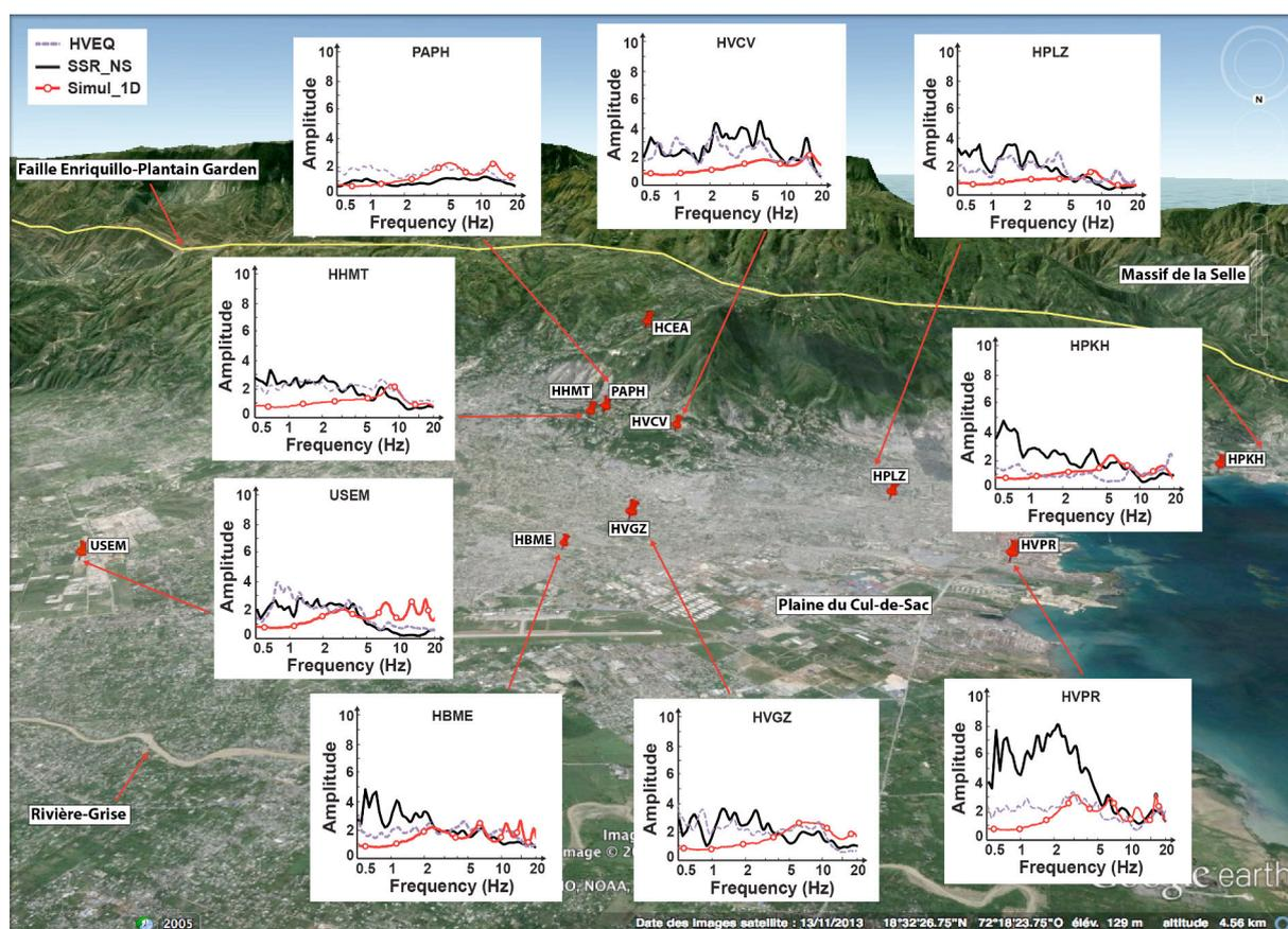
**Figure 5.4.-** Comparaison entre les fonctions de transfert empiriques (SSR et HVEQ) et numériques (simulations 1-D CyberQuake, *Modarelli et al., 1997*). La ligne noire montre les rapports spectraux moyens SSR pour la composante NS. La ligne rouge la simulation 1-D de la réponse sismique du sol et la ligne mauve discontinue les rapports moyens HVEQ.
