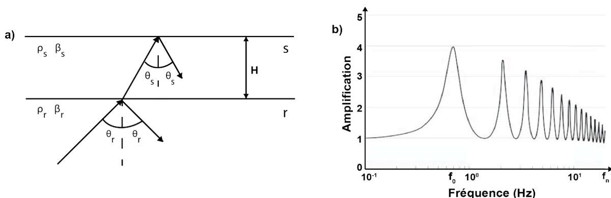
**Figure 4.4.- a)** Modèle de couche unidimensionnel (1D). Réflexion et réfraction d'une onde SH dans une couche de sol meuble (s) d'épaisseur  $H$  surmontant un demi-espace rocheux (r).  $\beta$  et  $\rho$  définissent la vitesse des ondes de cisaillement et la densité respectivement dans chaque milieu. **b)** Amplification en fonction de la fréquence  $|F(f)|$  pour un modèle unidimensionnel d'une couche de sol sur un demi-espace.
