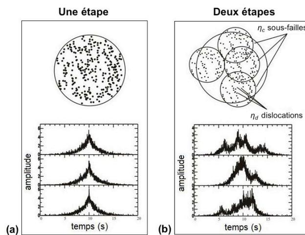
**Figure 6.5.-** Fonctions sources numériques temporelles générées à partir d'un schéma de sommation. **a)** Schéma de sommation en une seule étape proposé par [Ordaz et al. \(1995\)](#); **b)** Schéma de sommation en deux étapes proposé par [Kohrs-Sansorny et al. \(2005\)](#).
