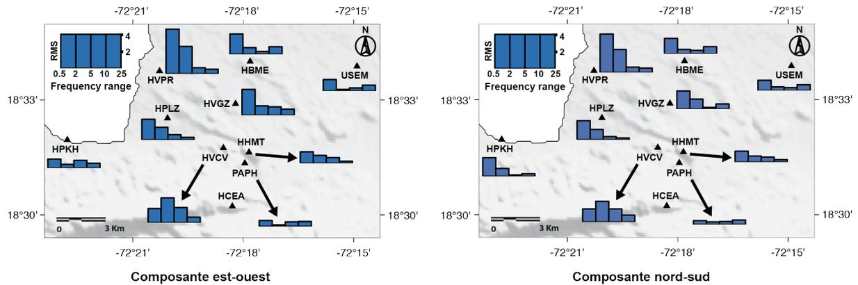
**Figure 5.5.-** Diagramme RMS (Root Mean Square) entre la simulation numérique 1-D du sol et les rapports spectraux SSR calculés pour différentes bandes de fréquences ([0.5 - 2 Hz], [2 - 2Hz], [5 - 10Hz] et [10 - 20Hz]). A droite, la composante est-ouest, et à gauche, celle nord-sud. Les triangles noirs indiquent la position des stations.
