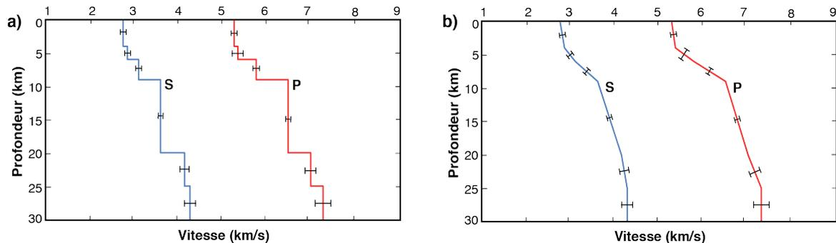
**Figure 3.5.-** a) Modèle de vitesse 1D utilisé par Douilly et al (2013) pour la localisation de certaines répliques du séisme du 12 janvier 2010. b) Modèle de vitesse 1D utilisé dans le cadre de cette étude. Il est déduit du modèle de vitesse de Douilly et al (2013), avec un gradient de vitesse dans les différentes couches afin d'éviter les forts contrastes d'impédance.
