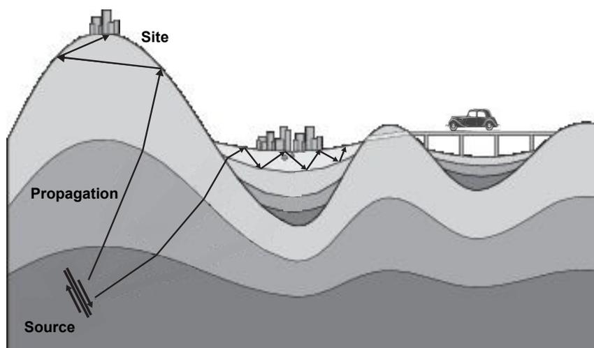
**Figure 4.1.-** Schéma de la propagation des ondes sismiques depuis la source où elles sont générées jusqu'aux sites considérés où elles sont enregistrées. Les conditions locales du site sont caractérisées par la présence de couches superficielles ayant des propriétés géotechniques différentes du substratum rocheux, et/ou la présence de structures topographiques (modifié d'après Semblat and Pecker, 2009).
