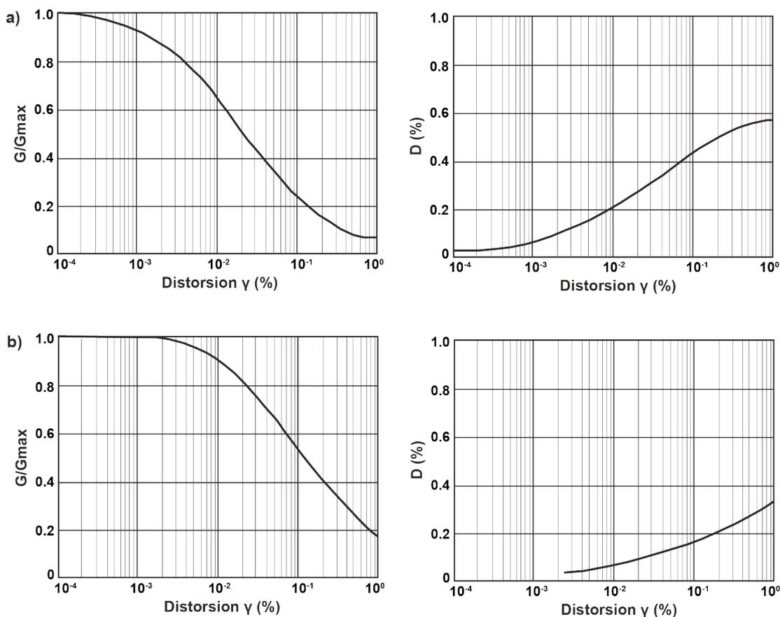
**Figure 5.2.-** a| Courbes de module de cisaillement normalisé (à gauche) et du coefficient d'amortissement (à droite) pour des sols sableux (Seed and Idriss, 1970). b| Variation, pour les argiles, du module de cisaillement normalisé (à gauche) et du coefficient d'amortissement (à droite) en fonction de la déformation (Vucetic and Dobry, 1991).
