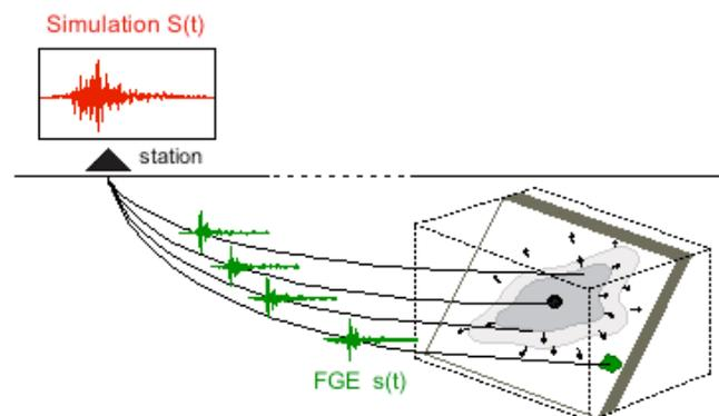
**Figure 6.1.-** Simulation des mouvements du sol d'un séisme cible  $S(t)$  (en rouge) par la sommation des enregistrements d'un petit séisme  $s(t)$  (en vert) décalés dans le temps pour reconstituer le processus de rupture. Figure extraite de [Kohrs-Sansorny, \(2005\)](#).
