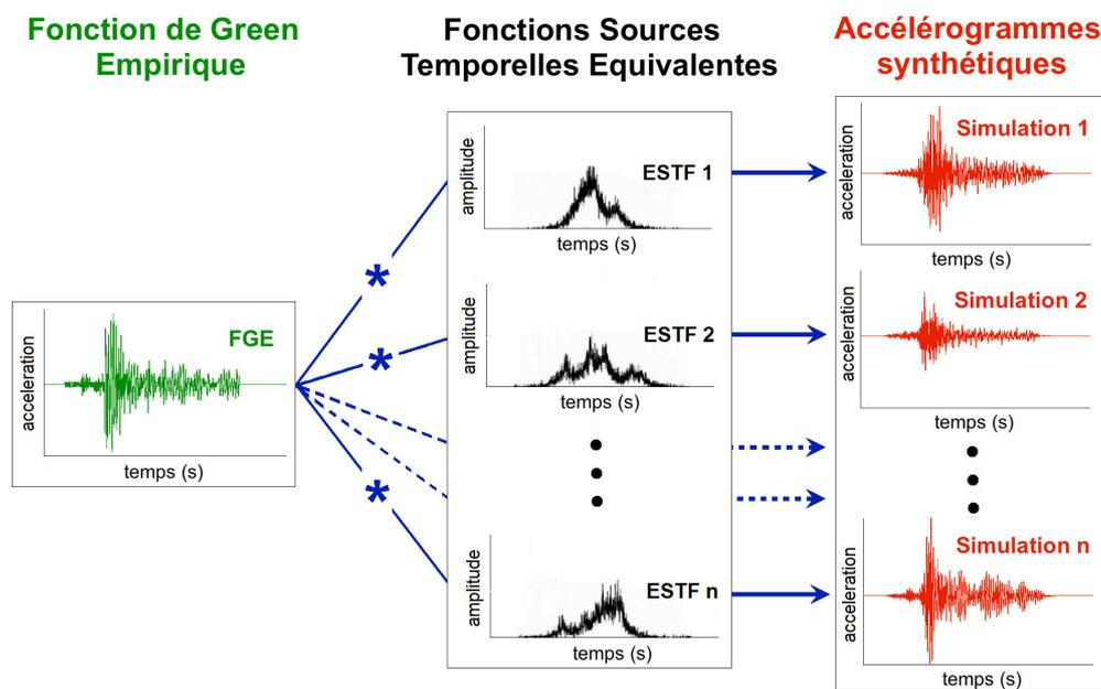
**Figure 6.6.-** Dans le domaine temporel, un grand nombre de fonctions sources temporelles (en noir) sont générées de manière aléatoire. Puis chaque fonction source temporelle représentative d'un processus de rupture donné est convoluée avec l'enregistrement du petit séisme utilisé comme fonction de Green empirique (en vert) pour produire un grand nombre d'accélérogrammes synthétiques (en rouge) (Honoré-Foundotos, 2013).
