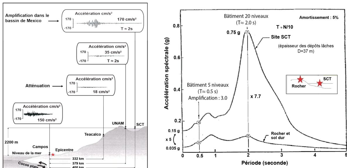
**Figure 4.2.-** Effet de site à Mexico lors du séisme de 1985. La figure de gauche fait état des signaux enregistrés à différents endroits et celle de droite relate l'amplification spectrale du mouvement sismique à Mexico sur un site au rocher et un site dans la zone lacustre, celle ayant provoqué la plupart des destructions des bâtiments de 10-20 étages (source : Bureau de Recherches Géologiques et Minières – Institut des Sciences de la Terre Grenoble).
