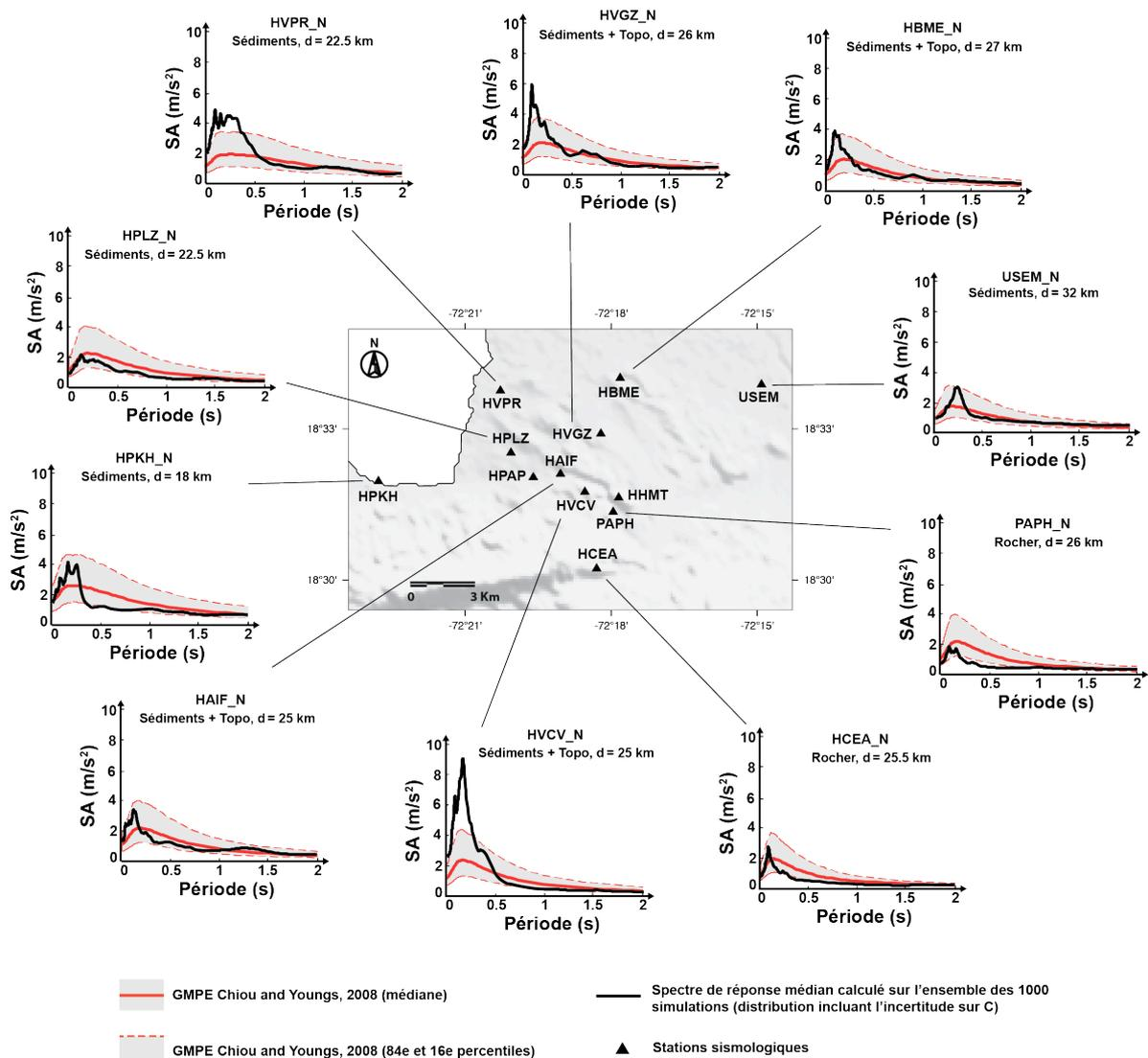
**Figure 6.20.-** Comparaison entre les spectres de réponse en accélération (5% d'amortissement critique) calculés pour la simulation d'un séisme cible  $M_w=6.5$  avec la Fonction de Green Empirique du 03 mai 2010, 19h21 (composante nord-sud) et ceux prédits par la GMPE [Chiou and Youngs, \(2008\)](#) pour un séisme de même magnitude. Les traits rouges discontinus représentent les 16ème et 84ème percentiles de la GMPE.
