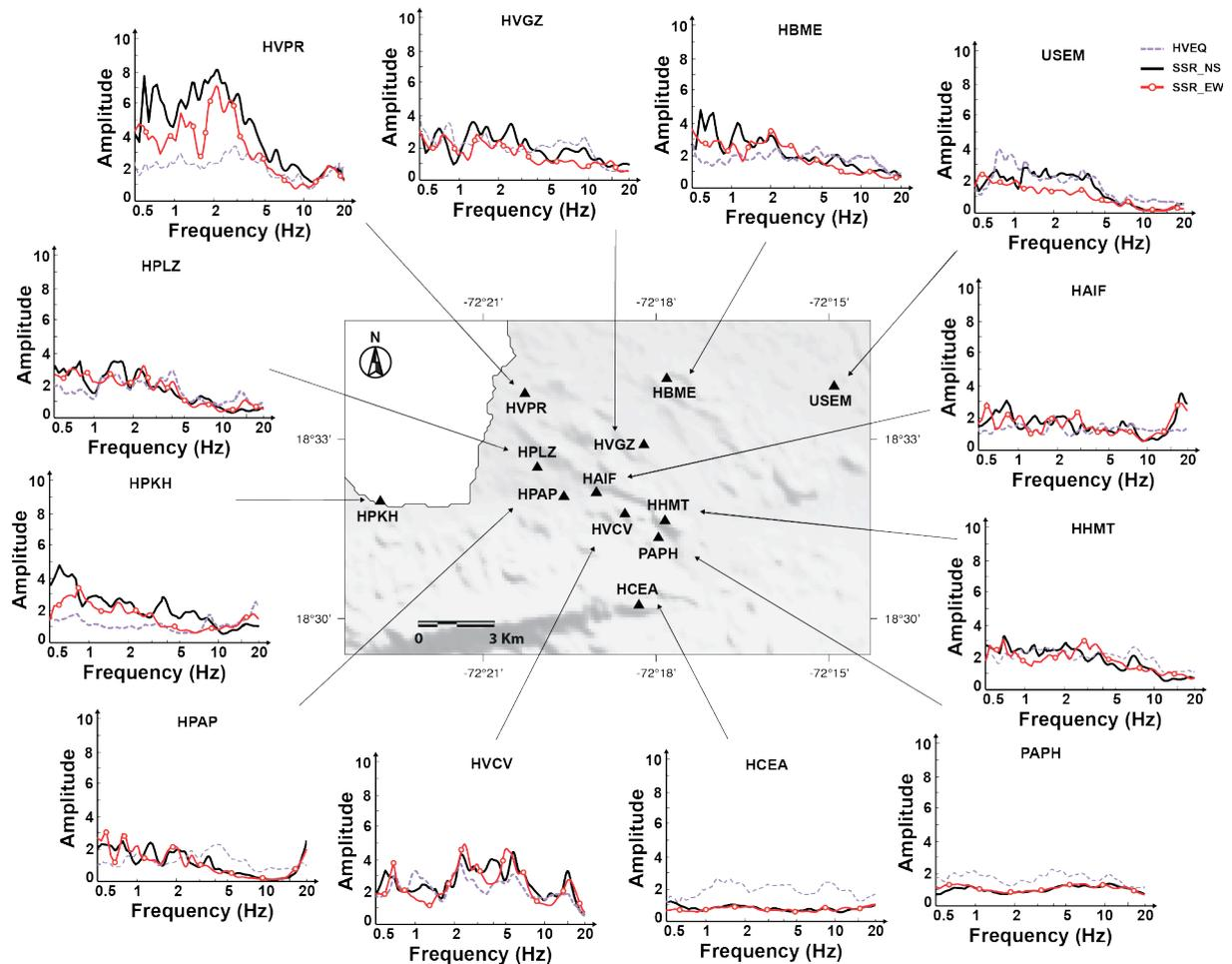
**Figure 4.14.-** Comparaison entre les méthodes de rapports spectraux HVEQ et SSR. Les lignes noires montrent les rapports spectraux SSR moyens pour la composante nord-sud. Les lignes rouges avec cercle vide les rapports spectraux SSR moyens pour la composante est-ouest et les lignes mauves discontinues les rapports spectraux HVEQ moyens. Les triangles noirs indiquent l'emplacement des différentes stations sismiques.
