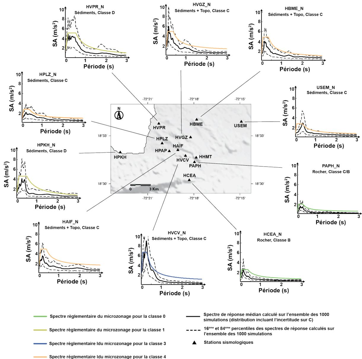
**Figure 6.26.-** Comparaison des spectres de réponse en accélération simulés avec la méthode EGF pour un séisme de magnitude 6.5 à 20km de la ville (ligne noire) aux spectres spécifiques du microzonage sismique de Port-au-Prince. Les spectres de réponse du microzonage ont été déterminés à partir des différentes cartes d'aléa sismique d'Haïti (Frankel *et al.*, 2011) et de la détermination des coefficients d'amplification  $F_a$  et  $F_v$  différents de ceux du NEHRP.
