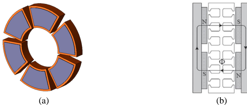
Figure IV.2. (a) Vue du stator de l'AGA et (b) vue du principe de fonctionnement des stators YASA [GIU12]
