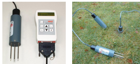
FIGURE 2.6 – Theta Probe : instrument permettant de calculer l'humidité du sol à partir des mesures de la constante diélectrique du sol.
