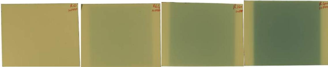
Figure IV-6 : Irradiation des films EBT3 selon 4 niveaux de dose pour réaliser la courbe de calibration, 0%, 16%, 40%, et 100% de gauche à droite
