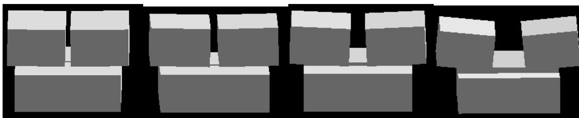
Figure III-5 : Modélisation Monte-Carlo des mâchoires X/Y, visualisation de l'ouverture des mâchoires Y, de 3x3 à 20x20 cm<sup>3</sup> (de gauche à droite).
