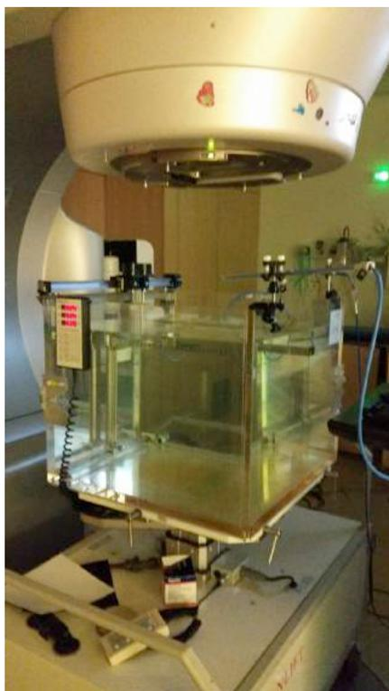
Figure III-12 : Cuve à eau modèle MP3 (PTW, Freiburg, Germany), dimension 40x40x40 cm<sup>3</sup>.
