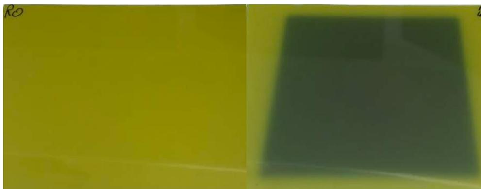
Figure IV-5 : Film Gafchromic<sup>®</sup> EBT3 vierge à gauche et irradié à droite, taille de champ 8x8 cm<sup>2</sup>, énergie 6X mode FFF.
