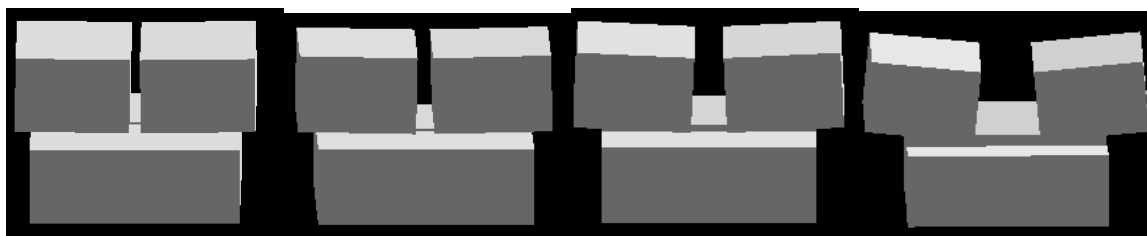
Figure III-5 : Modélisation Monte-Carlo des mâchoires X/Y, visualisation de l'ouverture des mâchoires Y, de 3x3 à 20x20 cm 3 (de gauche à droite).
