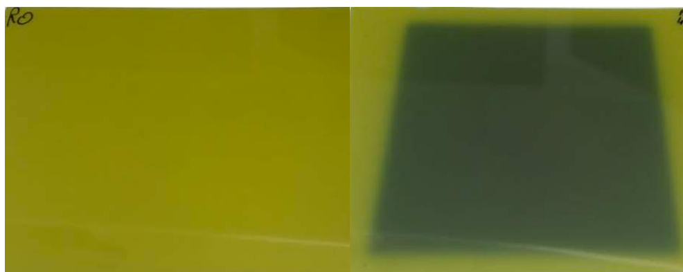
Figure IV-5 : Film Gafchromic ® EBT3 vierge à gauche et irradié à droite, taille de champ 8x8 cm 2 , énergie 6X mode FFF.
