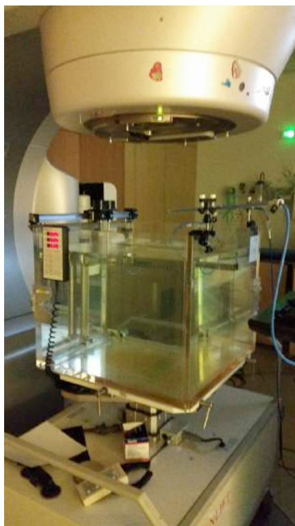
Figure III-12 : Cuve à eau modèle MP3 (PTW, Freiburg, Germany), dimension 40x40x40 cm 3 .
