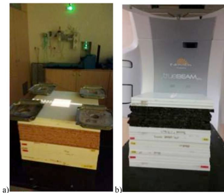
Figure IV-2 : a) Photo du fantôme hétérogène composé de liège non expansé à gauche ( \rho: 0,24 \text{ g.cm}^{-3} ); b) Photo du fantôme hétérogène composé de liège expansé à droite ( \rho: 0,12 \text{ g.cm}^{-3} )
