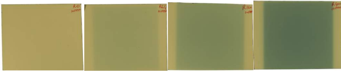
Figure IV-6 : Irradiation des films EBT3 selon 4 niveaux de dose pour réaliser la courbe de calibration, 0%, 16%, 40%, et 100% de gauche à droite
