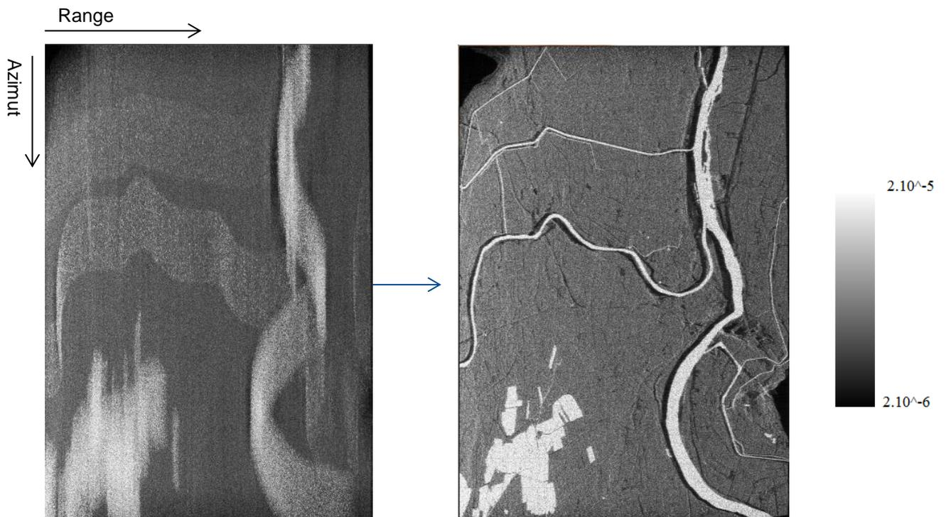
**Figure 35 : Focalisation dans le domaine temporel d'une donnée brute simulée sur le site de la Camargue (images d'amplitude)**
