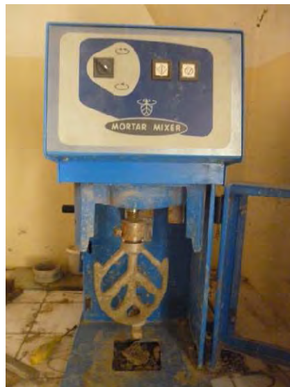
Figure 36 Photo du Malaxeur utilisé
