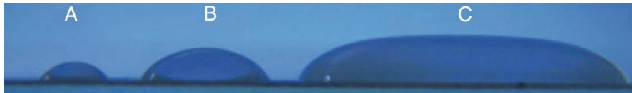
FIGURE 1.6 – Gouttes d'eau sessile en gravité terrestre à différents diamètres (et nombre de Bond). (A) correspond à B_o < 1 (diamètre inférieur à L_c ), (B) correspond à B_o \approx 1 , (C) correspond à B_o > 1 (diamètre supérieur à L_c ) [24].
