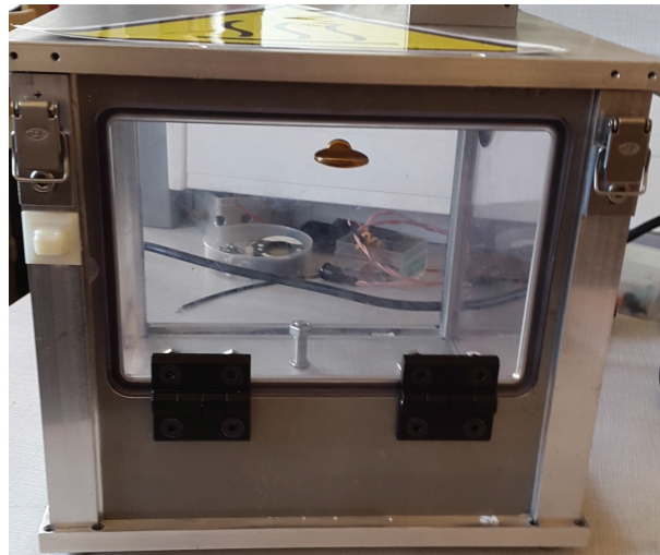
FIGURE 2.12 – Porte percée dans une paroi de la cellule facilitant son aération.
