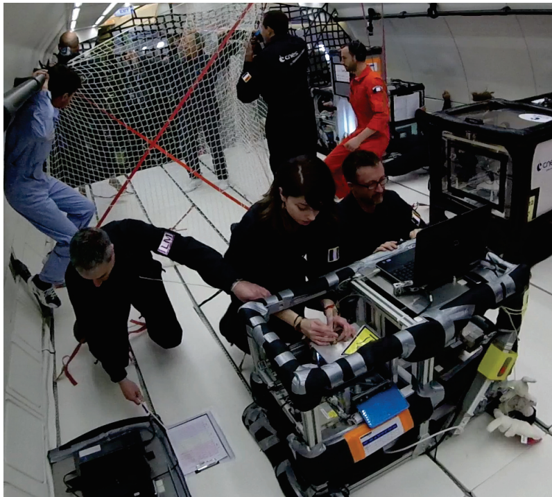
FIGURE 2.9 – Dispositif expérimental au complet avec un rack annexe sur le côté du rack principal pour pouvoir fixer les ordinateurs reliés aux caméras pendant les vols (CNES VP123, mars 2016).
