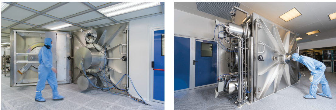
FIGURE 2.1 – Deux photographies du Grand Coater : à gauche, la face avant de la machine, côté salle blanche ISO3. A droite, l'arrière de la machine, côté salle grise. Crédits : Cyril FRESILLON/LMA/CNRS Photothèque.
