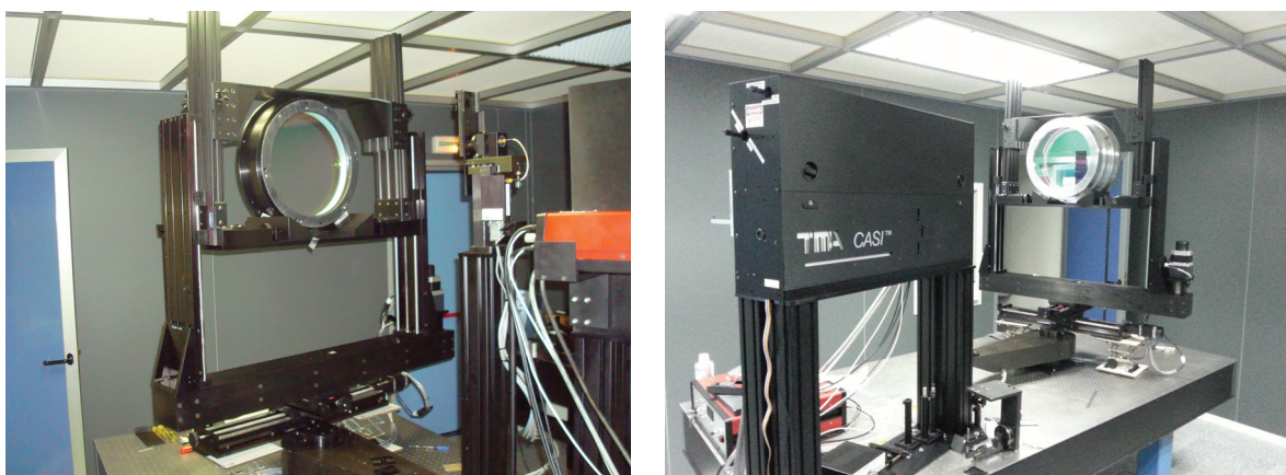
FIGURE 3.5 – Deux photographies du diffusomètre CASI. L'image de gauche montre la monture ainsi que le bras vertical qui peut se déplacer autour. L'image de droite est une vue un peu plus large montrant le coffret du laser et des optiques de focalisation.
