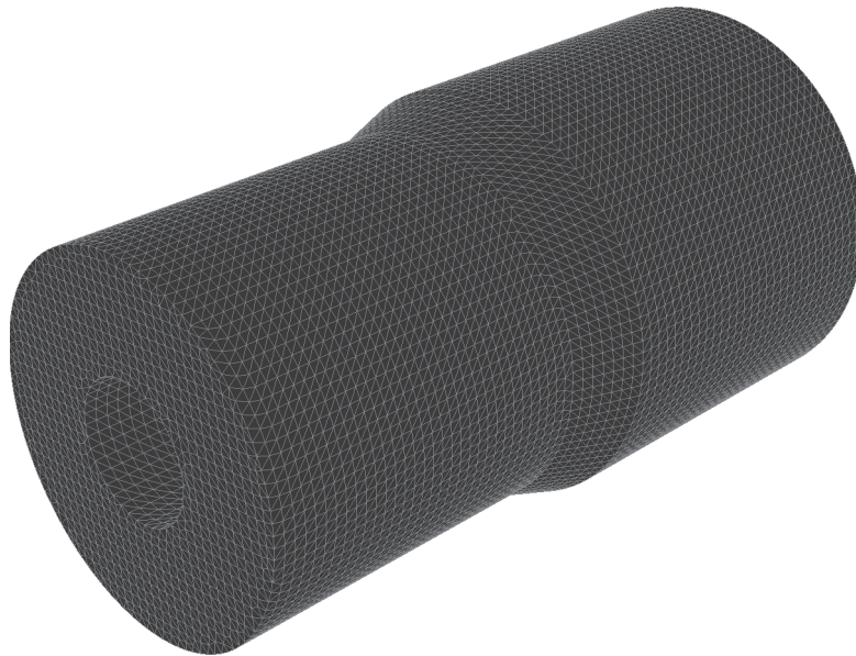
Figure 3.6 – Maillage d'une variation de section sur un tuyau en acier, 23 774 triangles
