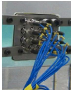
FIGURE 3.5 – Matrice de capteurs de pression PCB®
