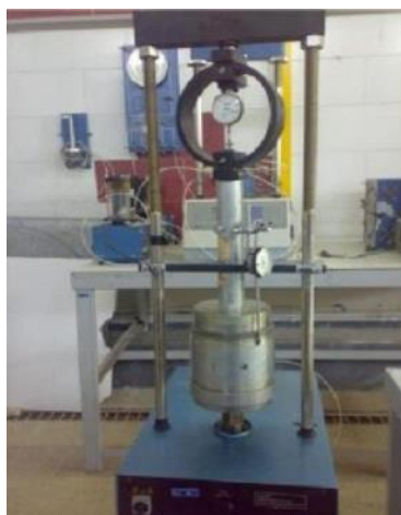
Figure 2-23 : Dispositif de poinçonnement pour l'essai CBR
