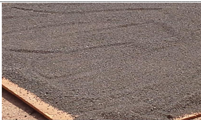
Figure 2-5 : Sol argileux séché (Lama1) et réduit à une taille inférieure à 5 mm
