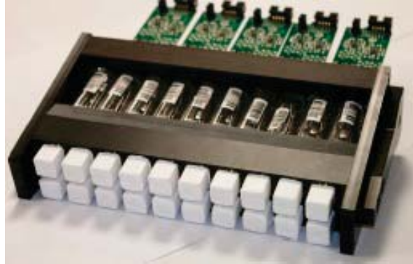
FIGURE 2.13 – Une ligne du DPGA avec ses 20 canaux de détection (5 quartets).
