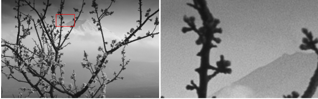
Figure 1.2: Bruit de mesure des niveaux de gris d'une image. En regardant de près l'image de gauche (on affiche à droite un grossissement de pixels contenus dans le rectangle rouge de l'image de gauche), il semble que les niveaux de gris mesurés ne traduisent pas exactement la réalité de la scène dont ils sont issus (on observe en effet des variations significatives de niveaux de gris dans des régions manifestement uniformes où l'on s'attend à observer des variations plus régulières des niveaux de gris). En pratique le processus d'acquisition introduit du bruit de mesure qui se traduit par des perturbations aléatoires sur les niveaux de gris mesurés.
