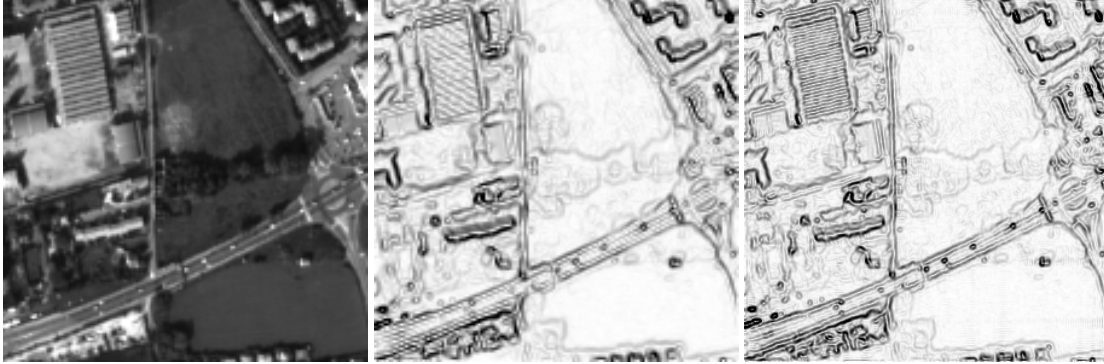
(a) image originale (© CNES) (b) \|\nabla u\| , différences finies (c) \|\nabla u\| , calcul sous-pixellique
