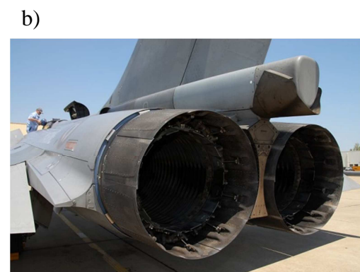
Figure 1.5 – a) les différents éléments CMC de protection thermique du projet de navette spatiale européenne Hermes. [Naslain 2005][ESA]. b) Volet secondaire en CMC du M88, moteur du Rafale [Herakles 2015] c) prototype de mélangeur CMC [Herakles 2015]
