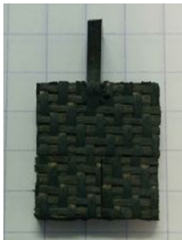
Figure II.5 – Préforme fibreuse avant infiltration, préparée pour être suspendu en zone chaude du réacteur.
