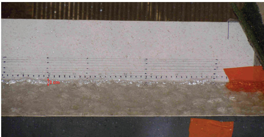
FIGURE 4.10 – Hauteur de la lame d'eau avec une pluie de 175 \text{ mm h}^{-1} .
