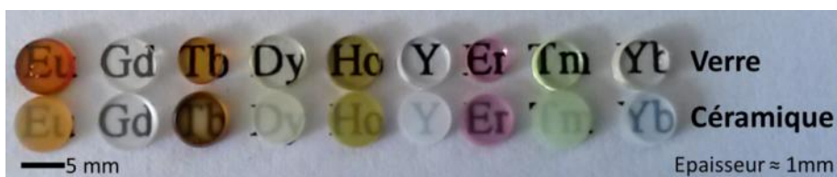
Figure IV.3 : Photographie des verres et céramiques polycristallines de SrREGa_3O_7 obtenues par cristallisation complète du verre grâce à un simple traitement thermique. Les échantillons sont polis sur deux faces parallèles.
