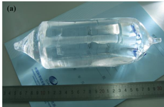
Figure 1.6 : Monocristal de YAG: Y_3Al_5O_{12} obtenu par la méthode de Czochralski selon la direction [111]. Le tirage est effectué avec une vitesse de 2 à 4 mm par heure, 3 jours de tirage sont nécessaires pour obtenir un monocristal de 240 mm de long avec un diamètre de 80 mm. 44
