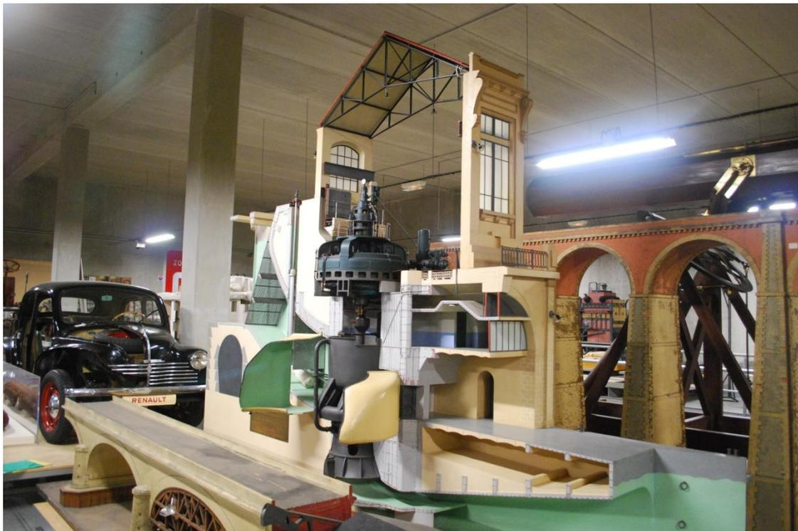
Figure 95 : Maquette au 1/10<sup>è</sup> d'une coupe de l'usine barrage de Cusset (C.N.A.M.)
