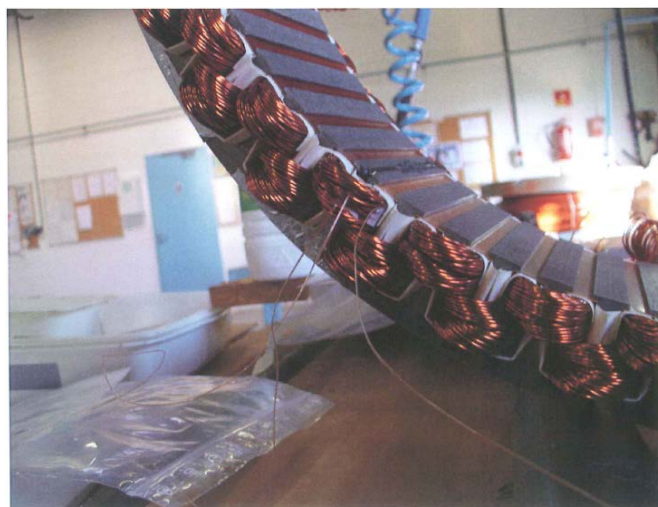
Figure V-6 : Photo du bobinage du prototype et de l'instrumentation du bobinage
