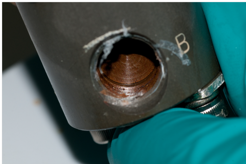
Figure 3.7: Effet de l'iode sur les parois : corrosion du tube en inox par l'iode solide à pression atmosphérique [49].
