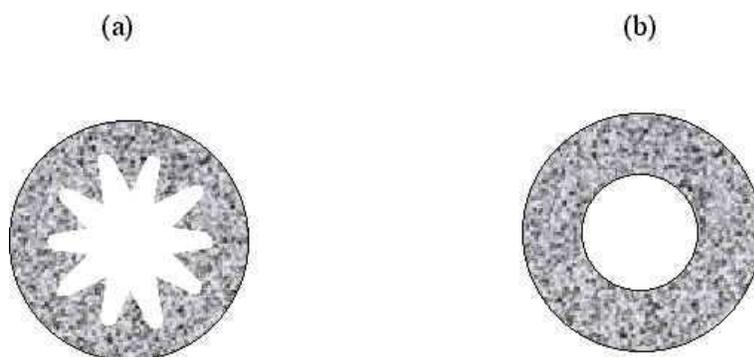
Figure 1.9 : différentes configurations de canal central
